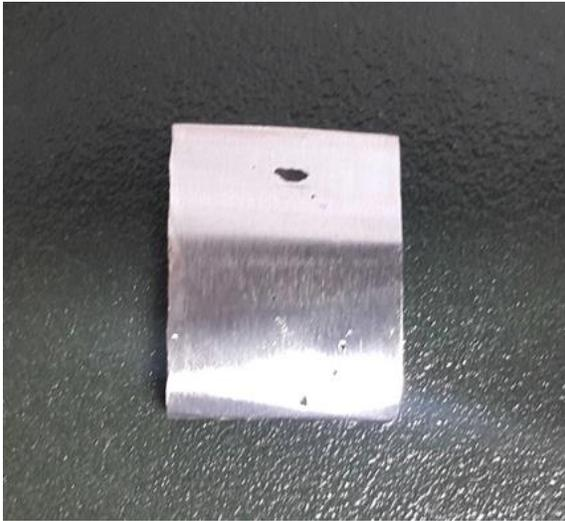
*Figura 23 Electrodo de trabajo lijado (hasta lija 600)*
