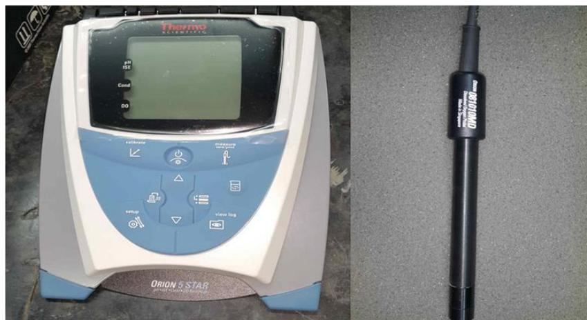
Figura 25 Equipo y sonda para medir concentración de oxígeno
