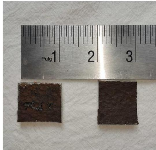
*Figura 24 Electrodos de trabajo*
