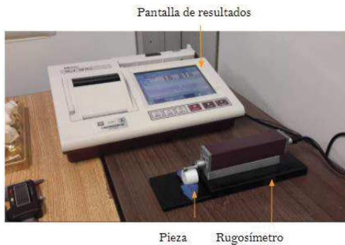
Figura 42 Medición de rugosidad de una pieza de policarbonato con el equipo Mitutoyo SJ 310.
