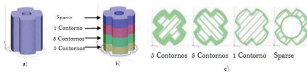
Figura 36 Secciones con distintos parámetros de manufactura en las piezas de PC a) Imagen CAD del componente diseñado b) Secciones con distintos contornos c) Configuración de los contornos en el componente.
