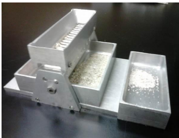
Figura 6. Cuarteador de Rifles. Laboratorio de Sedimentología. Instituto de Ciencias del Mar y Limnología.
