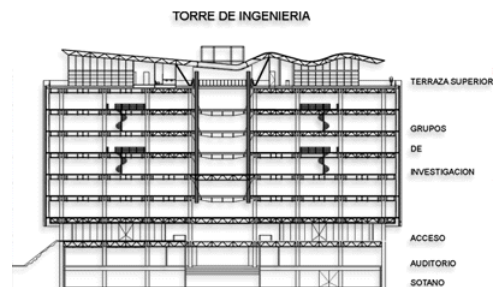
Figura 18. Corte de la Torre de ingeniería de la Universidad Nacional Autónoma de México. Recuperado de: http://www.torreingenieria.unam.mx/htm/info1.html . (2017).
