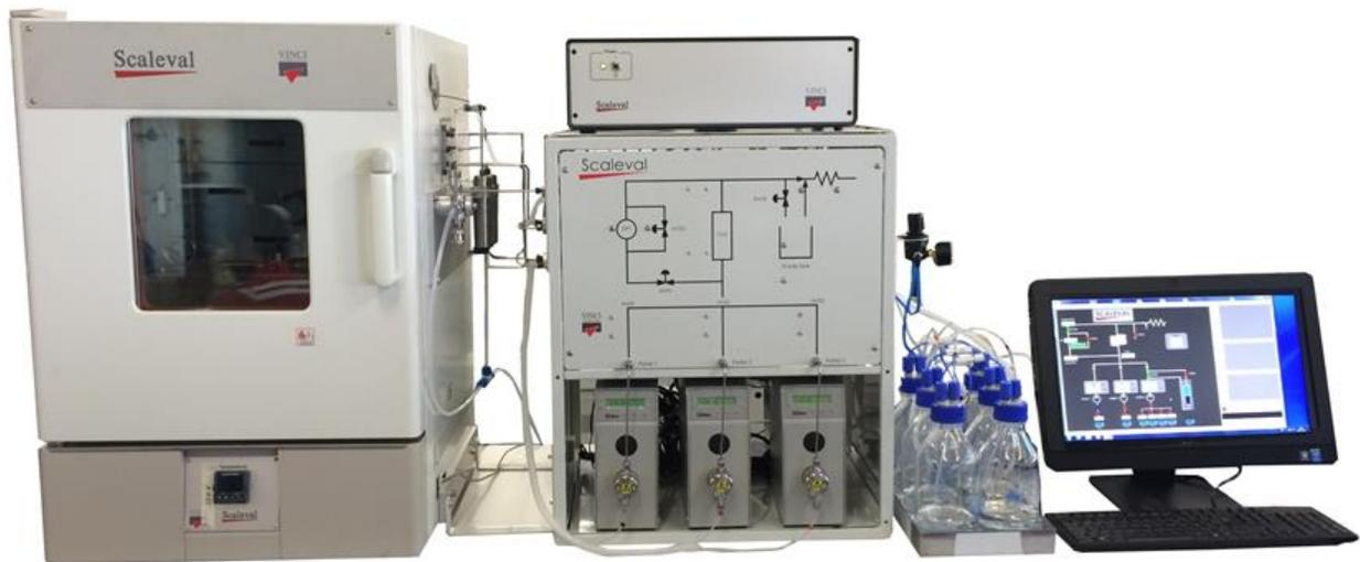
Fig. 11 Aparato SCALEVAL utilizado para el DSL. Fuente. <http://www.vindum.com/product-detail/dynamic-scale-loop/>
