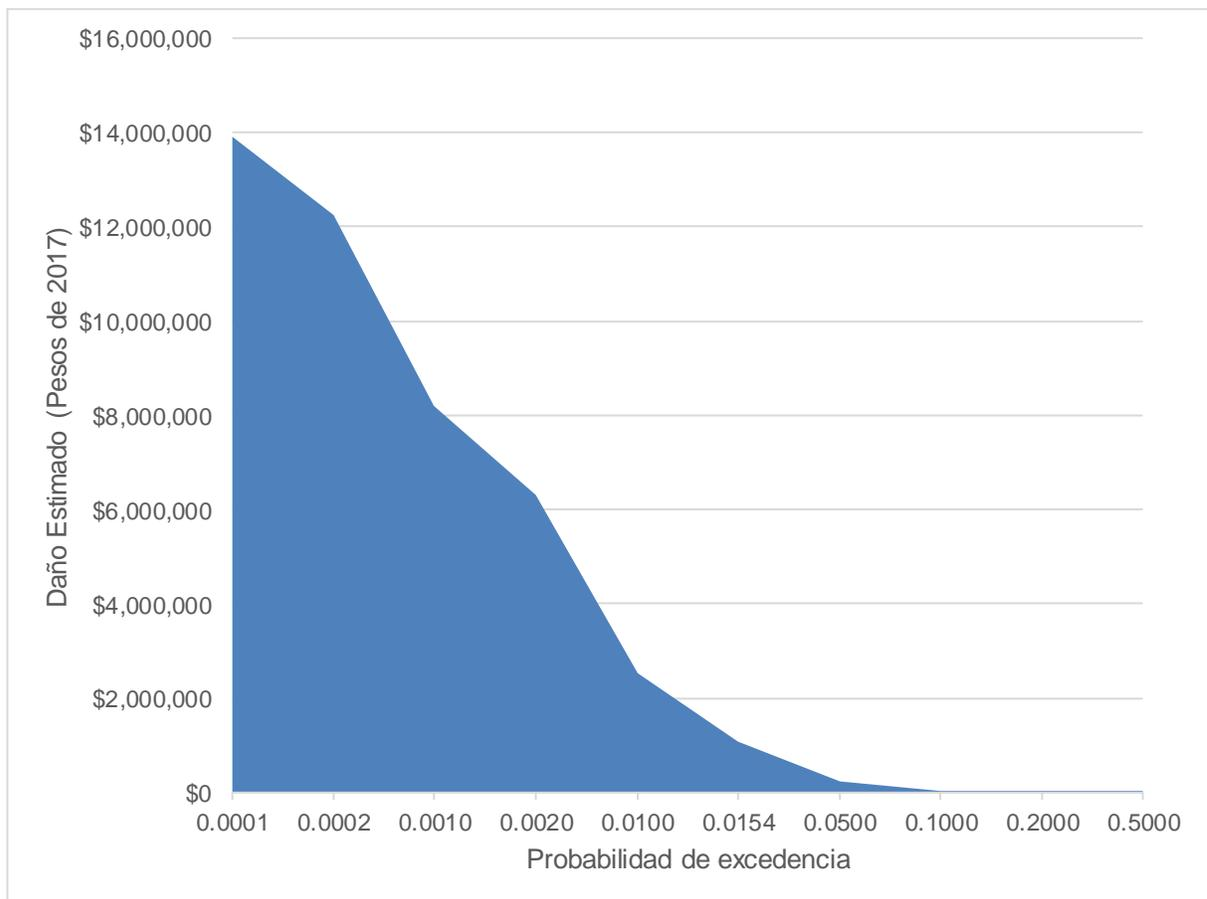
Figura 4.12 Representación del daño anual esperado más probable en Frontera Corozal, Chiapas, México
