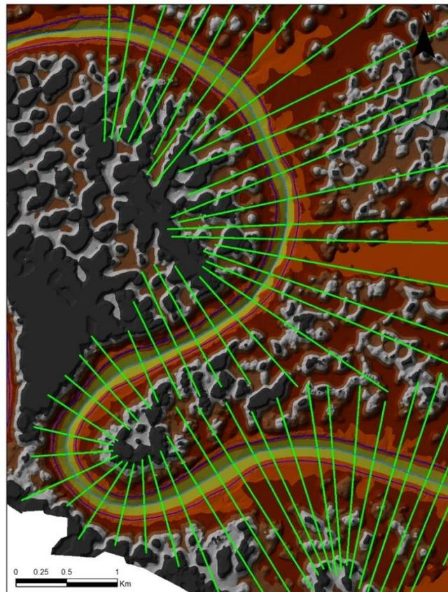
Figura 3.4 Generación de la geometría a modelar. Hec-GeoRAS
