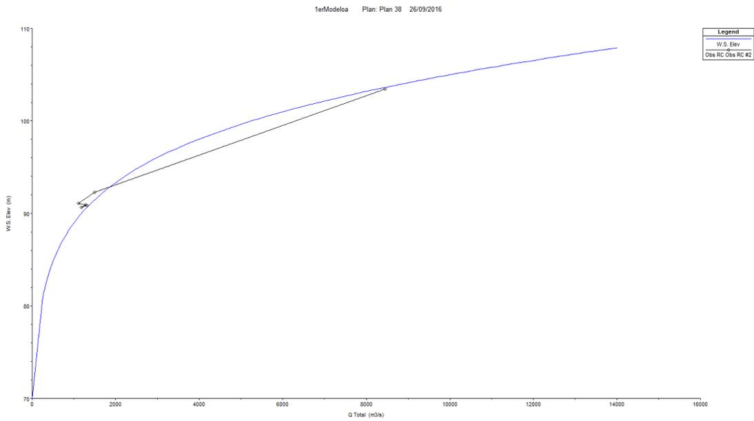
Figura 3.17 Curva gastos-elevaciones obtenida en la sección +101 161.8 correspondiente a la casa aislada entre Yaxchilan y Frontera Corozal
