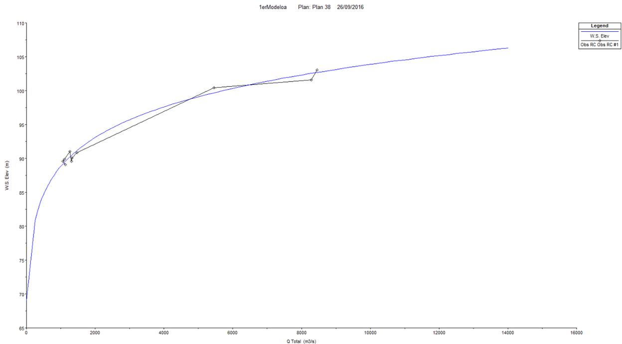
Figura 3.16 Curva gastos-elevaciones en la sección +91 019.86, correspondiente a la pista de aterrizaje Yaxchilán, frontera del modelo aguas abajo.
