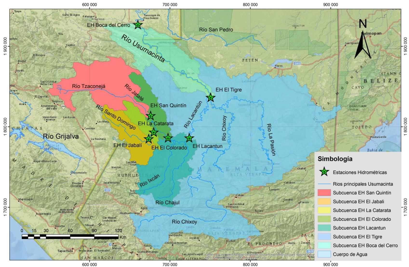
Figura 2.4 Localización y cuencas de drenaje de las Estaciones Hidrométricas seleccionadas
