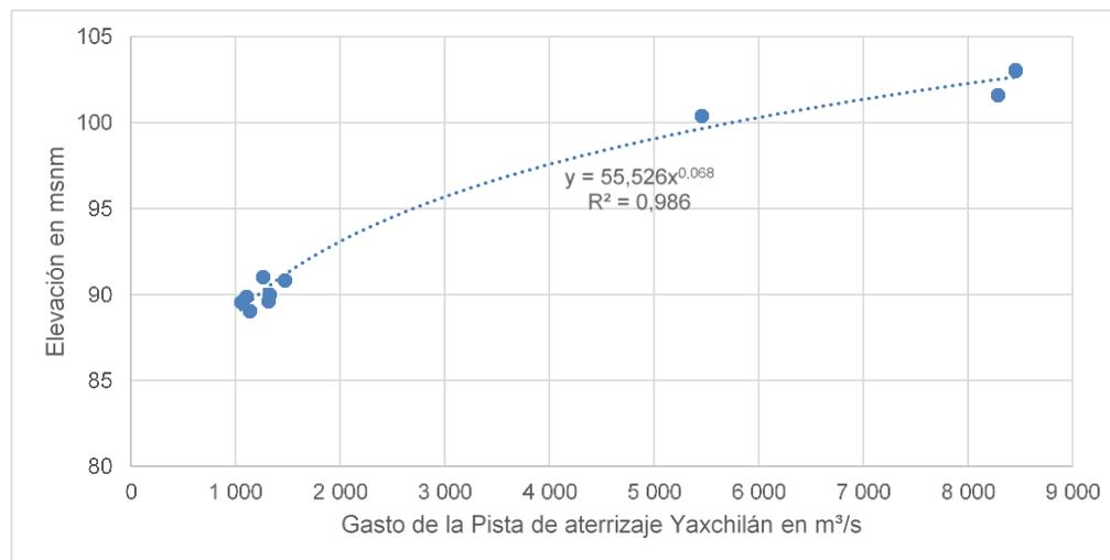
Figura 3.7 Condición de frontera aguas abajo.
