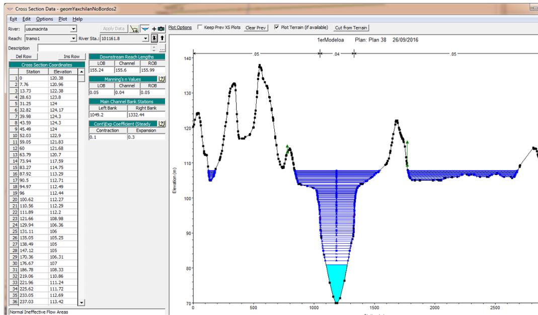
Figura 3.6 Secciones transversales provenientes de Hec-GeoRAS en Hec-RAS
