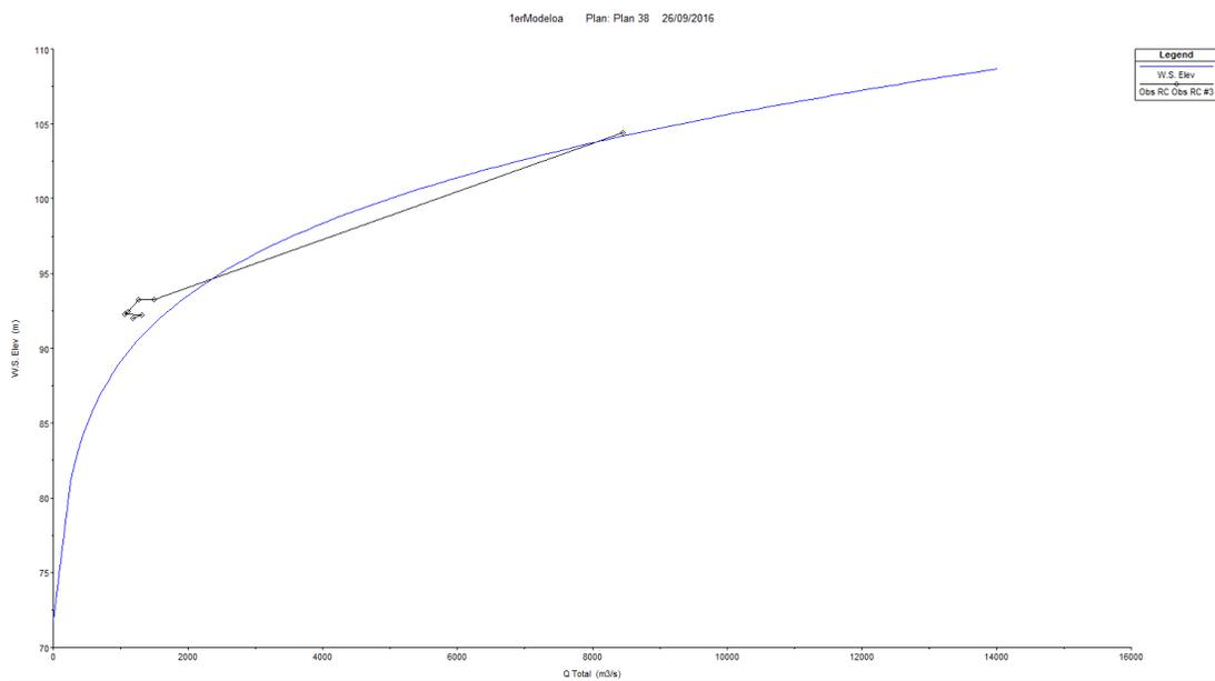
Figura 3.18 Curva gastos-elevaciones obtenida en la sección +109 592.9 correspondiente al embarcadero en Frontera Técnica, Guatemala
