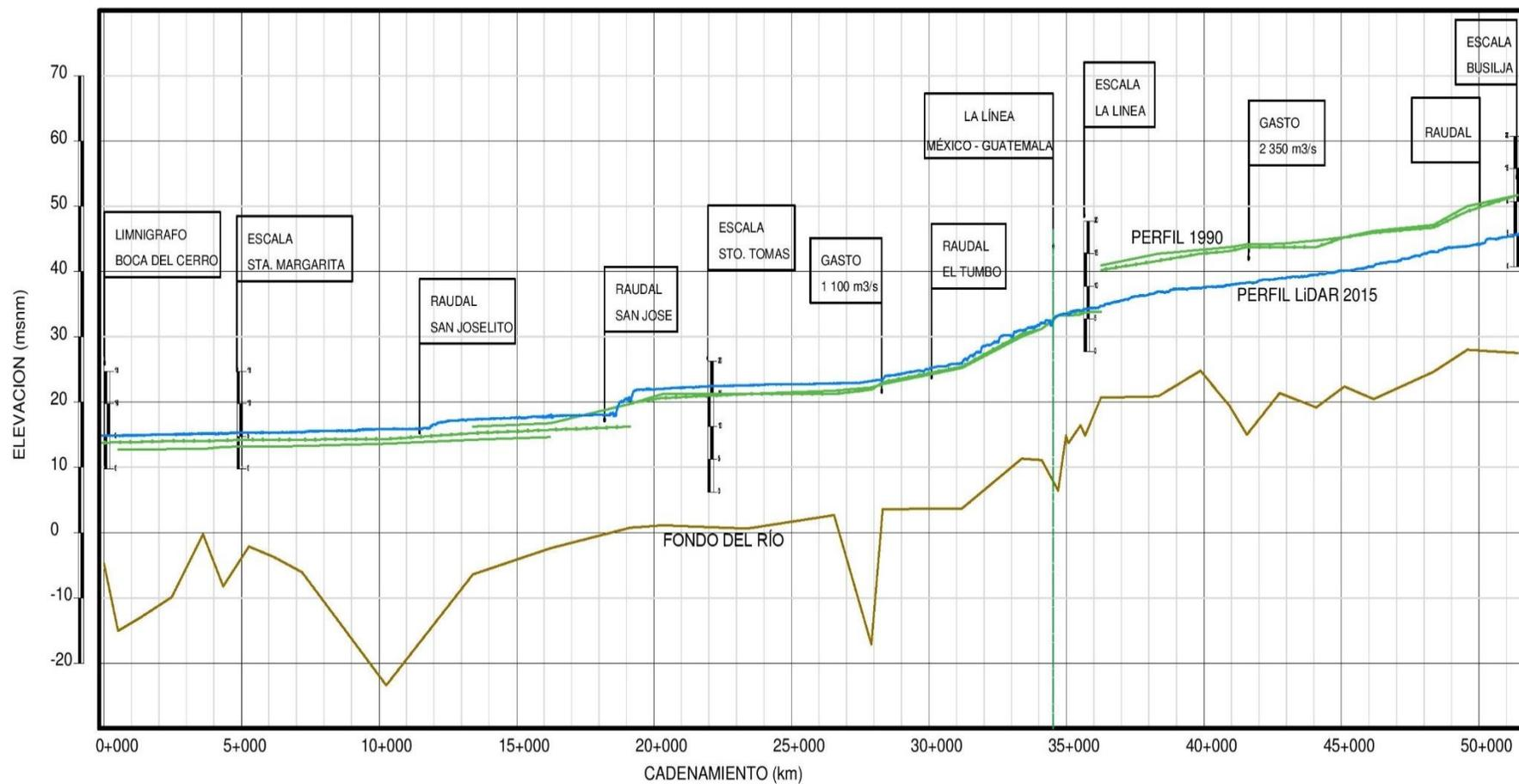
Figura 3.3 Perfil obtenido por GEIC en 1990 comparado con el obtenido en 2015 en el estudio LiDAR (SAP, 2015)
