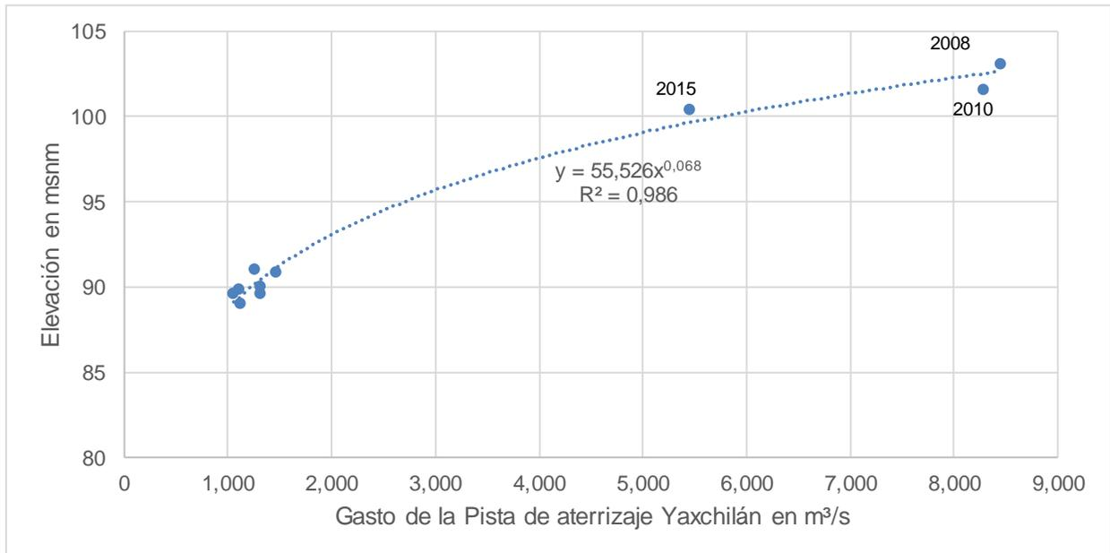
Figura 3.11 Curva gastos-elevaciones en la Pista de aterrizaje Yaxchilán
