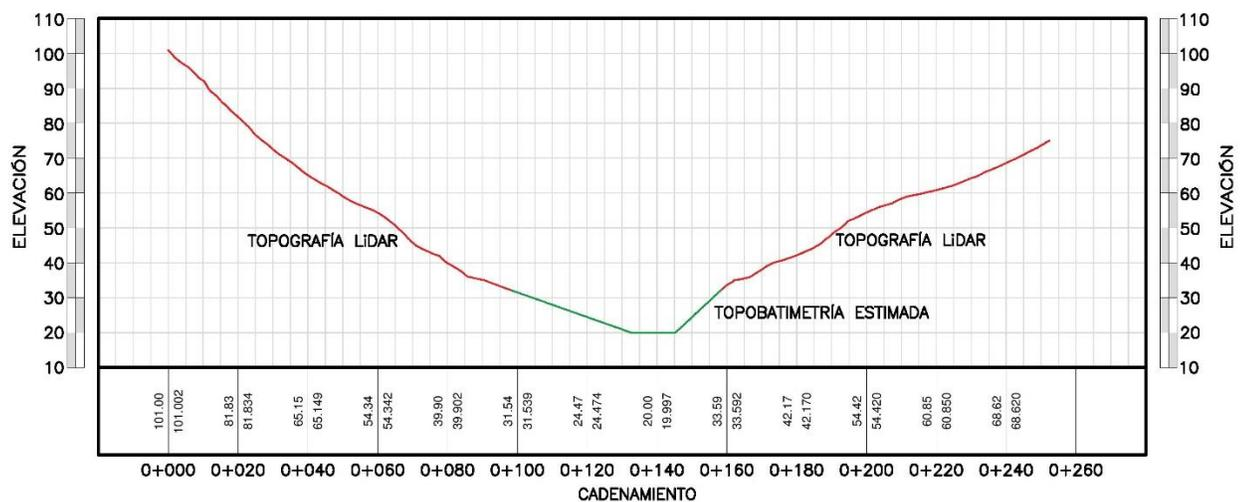
Figura 3.2 Sección tipo obtenida mediante la interpolación del fondo del río
