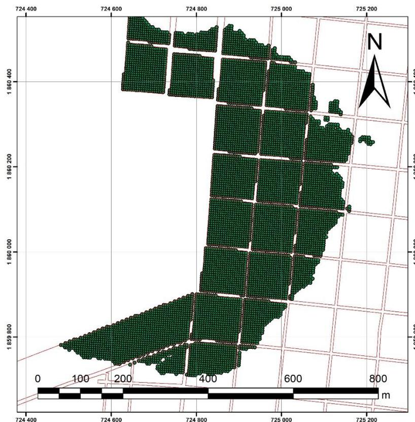
Figura 4.11 Intersección del shape de tirantes con el de manzanas para un periodo de retorno de 100 años en Frontera Corozal, Chiapas, México
