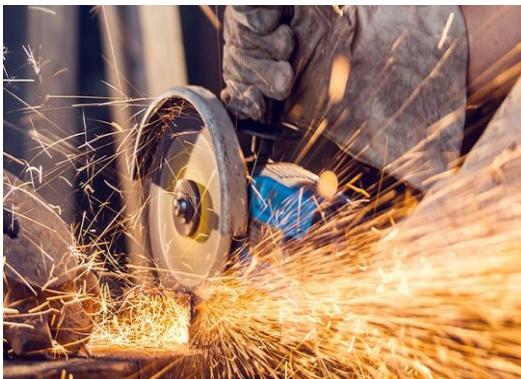
Imagen 3. Corte de metal con disco abrasivo.
