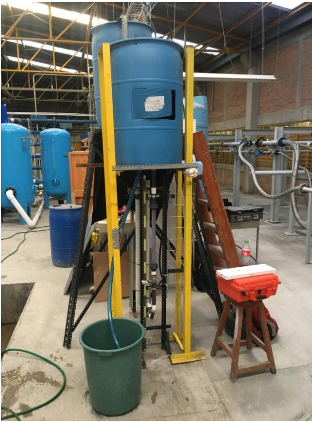
Figura 2.2. Fotografías del sistema analógico experimental (derecha) y de la distribución de los sensores acoplados a la sección de pruebas, previo a la fase de experimentación (izquierdo).
