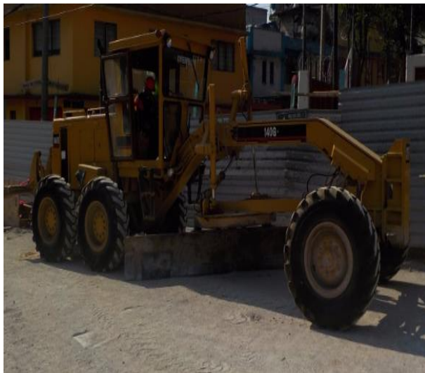
Ilustración 8. Motoconformadora CAT 140 G, fotografía tomada por el autor, 2017.
