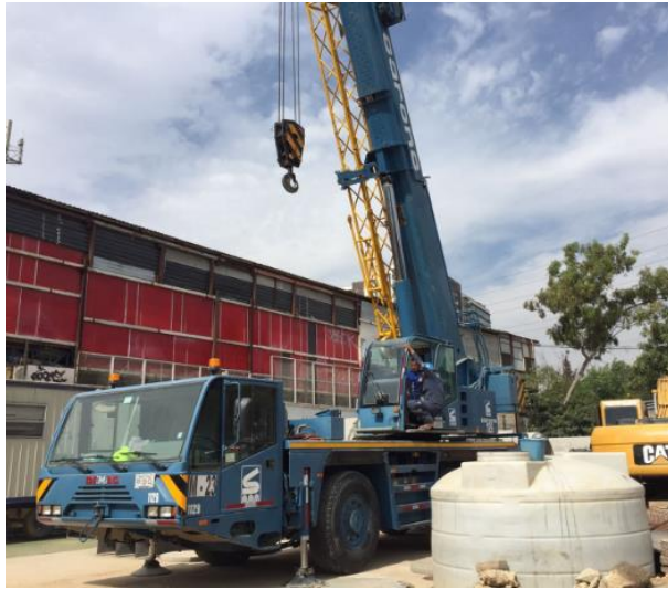
Ilustración 10. Grúa telescópico SARENS de 50 ton, Espíndola A., 2017.
