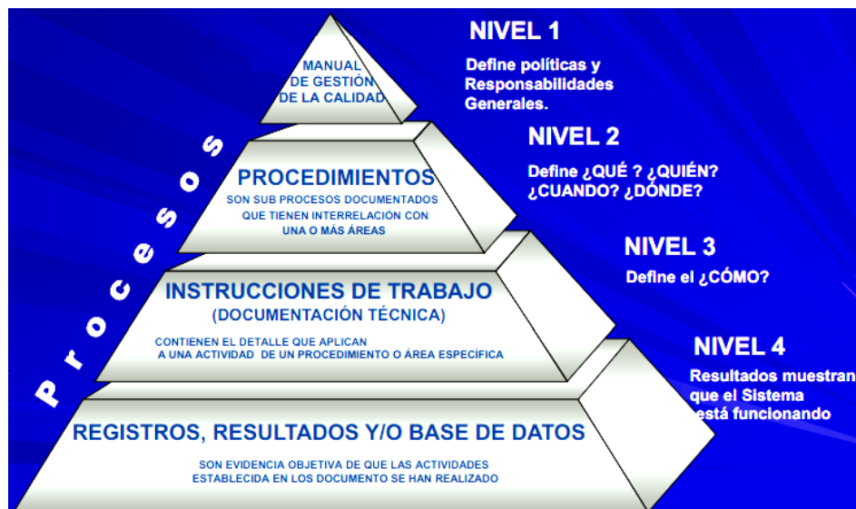
Figura 9. Descripción de la documentación de un Sistema de gestión de la Calidad
