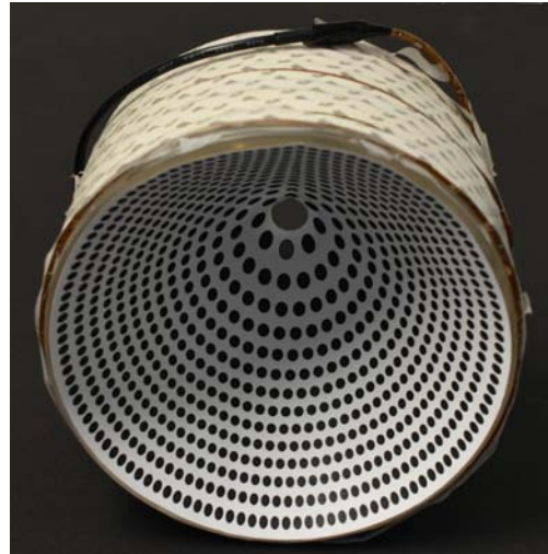
Figura 4.2: Cono con la pantalla nula diseñada para una esfera de 7.8 mm de radio
