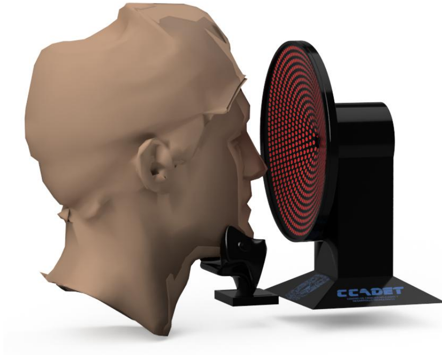
Figura 5.1: Prototipo de topógrafo corneal cónico basado en pantallas nulas
