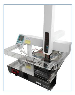
**Fotografía 2.** Equipo automatizado para la hidrólisis de carbonatos CHS IonPlus.
