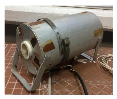
**Fotografía 1.** Horno eléctrico cilíndrico. Se observa el tubo cerámico al centro en el cual se introdujeron las muestras para su calcinación.
