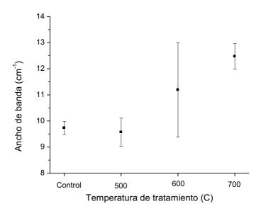
Fig. A4. Cambio en el ancho de banda promedio con respecto a la temperatura de tratamiento.
