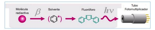
**Figura 8.** Principio del funcionamiento de detección de emisión beta por centelleo líquido. El solvente absorbe una porción de la energía de la emisión beta hasta llegar a un fluoróforo, este absorbe la energía y la reemite en forma de luz. Modificado de [24]
