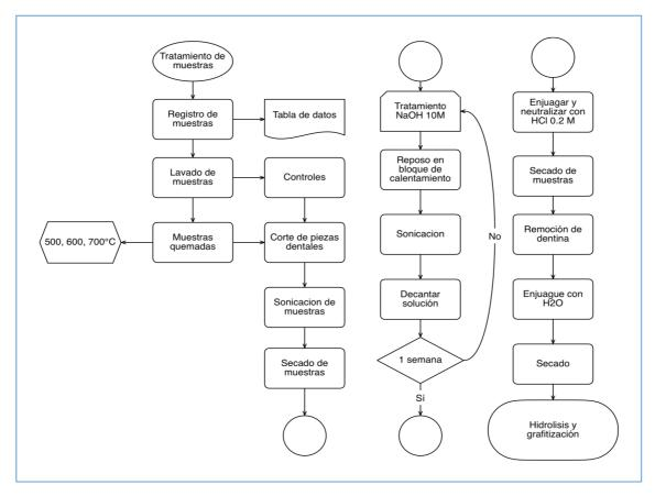
**Figura 18.** Diagrama de flujo para el pretratamiento y grafitización de carbonatos.
