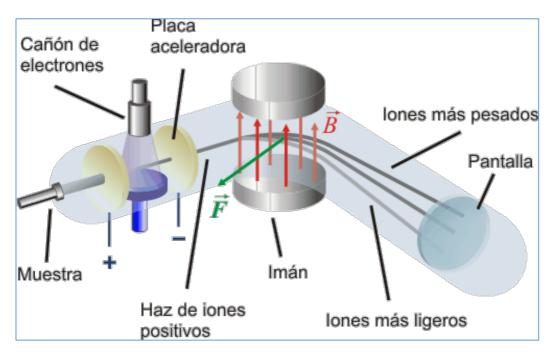
**Figura 11.** Fundamento de la espectrometría de masas. El proceso de análisis consta de cuatro etapas 1) Ionización, 2) Aceleración, 3) Dispersión de iones, 4) Detección. Tomado de [46]
