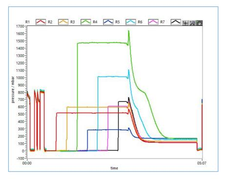
**Figura 19.** Proceso de grafitización en el software proporcionado por IONPlus. Se observan tres etapas, la primera es el acondicionamiento del hierro. En la segunda etapa se cargan los reactores
