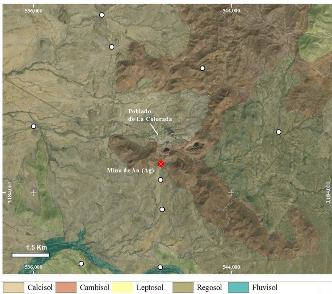
Figura 4. 7 Mapa mostrando imagen satelital del cuadrante que incluye la mina de Au (Ag) en el que se muestra los tipos de suelo y puntos de muestreo en suelos superficiales. Mapa realizado a partir de la digitalización de Cartas Edafológico H12-8 y H12-8, INEGI (2007). Esri, Digital Globe, GeoEye, i-cuber, USDAm AEX, Getmspping, Aerogrid, IGN, IGP, swisstopo, and the GIS User Community.
