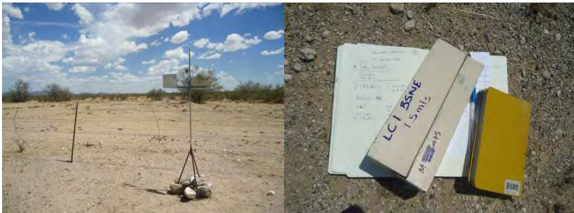
Figura 4. 11 Colector de polvo BSNE en campo (izquierda) y caja captadora de polvo (derecha).
