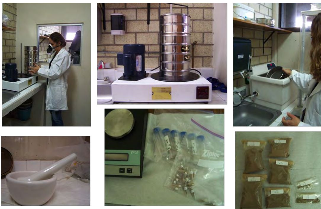
Figura 4. 8 Fotografías ilustrando algunos procedimientos de preparación de muestras para su posterior análisis geoquímico. En orden de aparición de izquierda a derecha se muestra: (1) Proceso de tamizado mediante RoTap; (2) Lavado de tamices en baño ultrasónico; (3) Mortero para disgregar suelo; (4) Balanza con muestras etiquetadas para distintos análisis; y (5) Ejemplo de fracciones de muestra de suelo después del tamizado.
