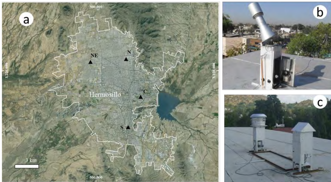
Figura 4. 10 a) Localización de los puntos de muestreo de polvo suspendido en Hermosillo; b) ejemplos de puntos de muestreo con un colector manual de alto volumen (HV, por sus siglas en inglés) PM_{10} de la marca Wedding & Associates modelo wedding 600/1140921538U; c) punto de muestreo de polvo suspendido con dos colectores de alto volumen PST (Modelo TE-5000, Tish Environmental Inc.) y PM_{10} (Modelo Andersen TE-6070V Tish Environmental Inc.).
