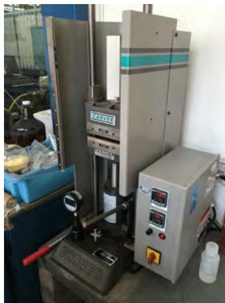
Figura 14. Fotografía de la prensa Carver modelo 4386 con control de temperatura.
