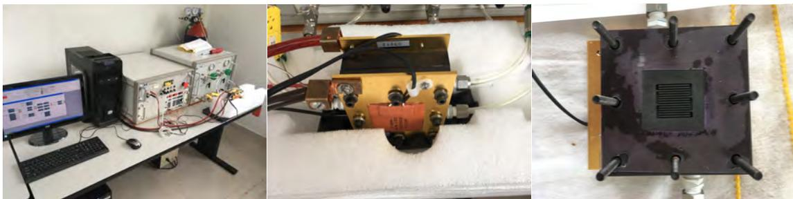
Figura 15. Fotografías de la estación eléctrica y monocelda de estudio.
