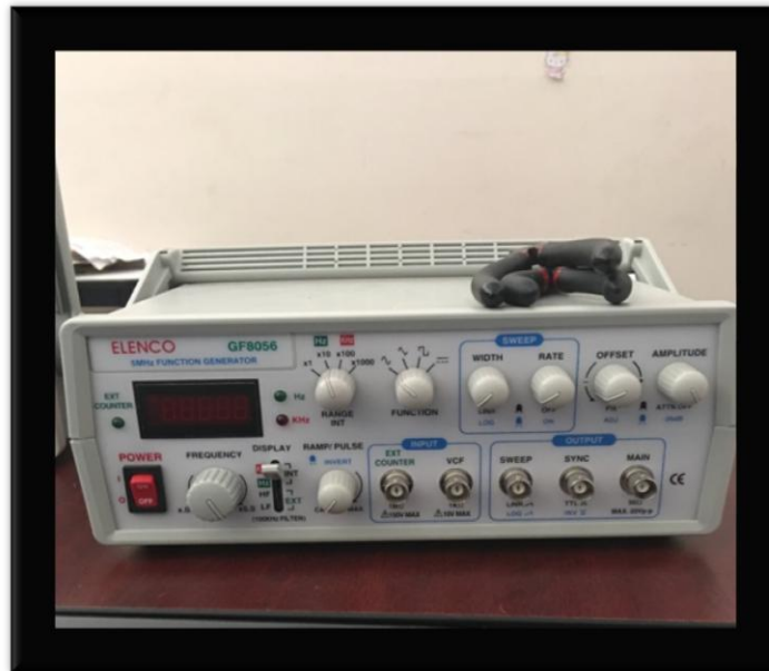
Figura 9. Generador de funciones ELENCO GF8056.
