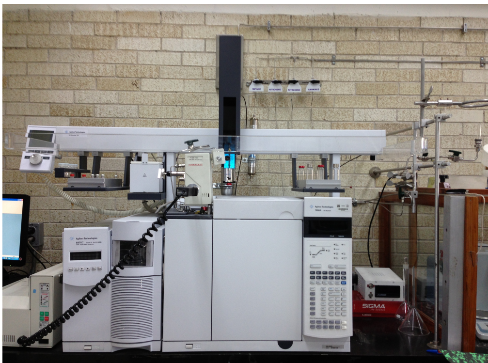
Figura 6.11. Cromatógrafo de gases acoplado a un espectrómetro de masas en el laboratorio de Química de Plasmas y Estudios Planetarios en el Instituto de Ciencias Nucleares de la UNAM.
