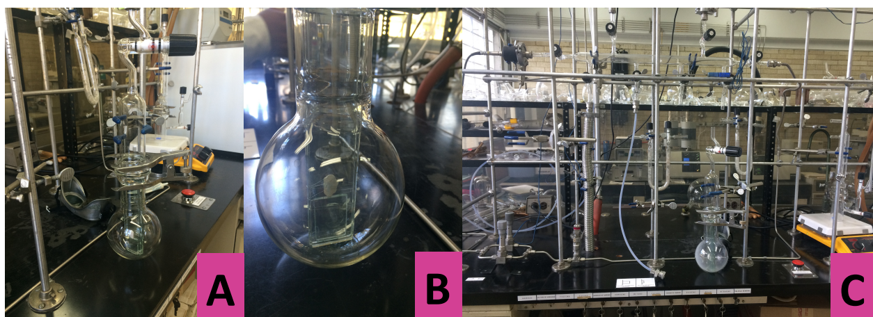
Figura 6.8. Reactor con placa de vidrio utilizado en la simulación de Chicxulub. En la parte A se puede observar el reactor conectado a la línea de vacío, en la parte B se observa la muestra sostenida por placas de vidrio dentro del reactor y en la parte C se da una vista completa de la línea de vacío.
