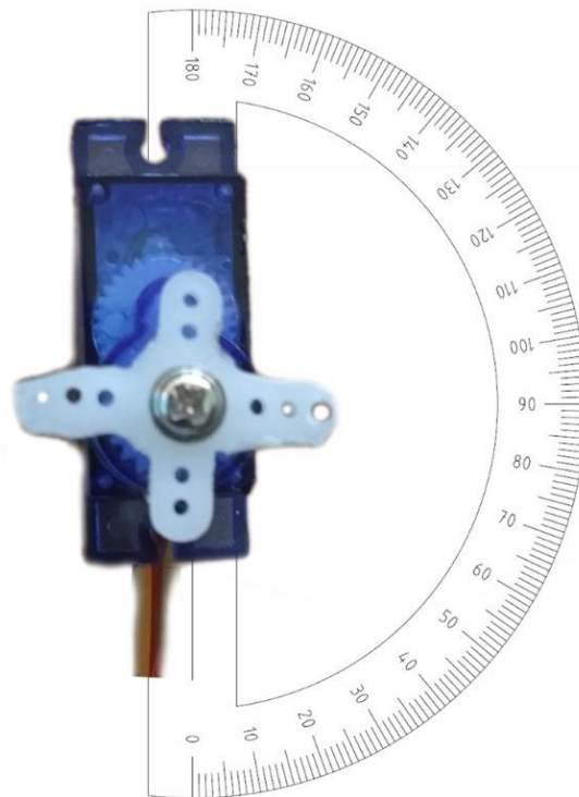
Imagen 4. 224 Ángulo de inicio del servomotor.
