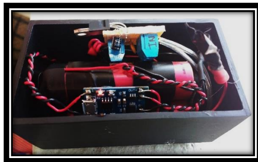
Imagen 4. 191 Sistema propuesto con módulo TP4056.
