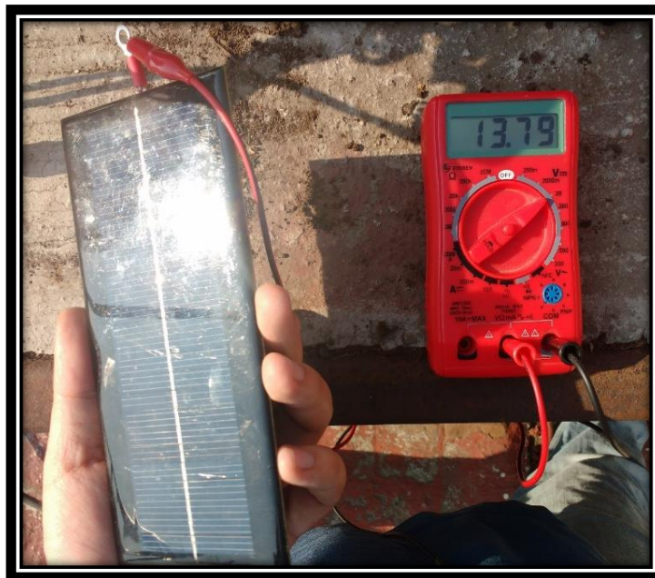
Imagen 4. 6 Medición panel solar 12V.
