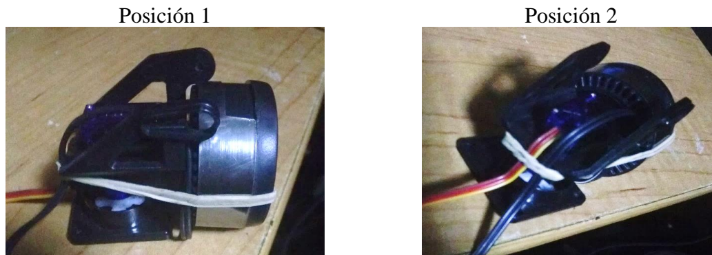
Imagen 3. 7 Conexión de servomotor.
