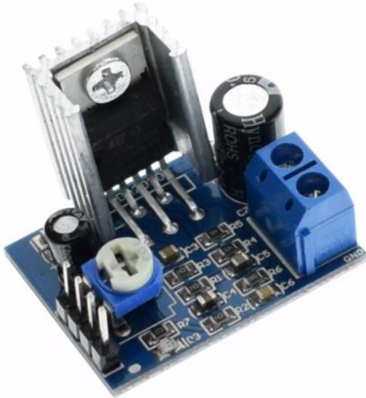
Imagen 2. 30 Módulo amplificador de audio TDA2030A.
