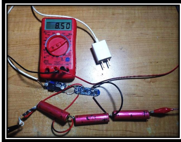
Imagen 4. 85 Voltaje inicial de celdas Ion Litio.
