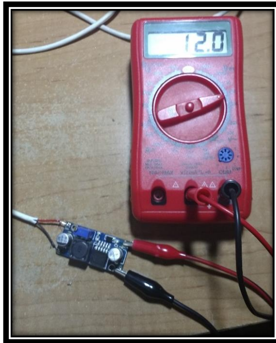
Imagen 4. 63 Elevador de voltaje DC- DC.
