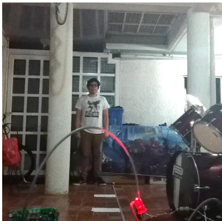
Imagen 4. 268 Prueba de distancia sensor PIR.
