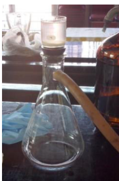
Figura 36. Filtración por medio de vacío.
