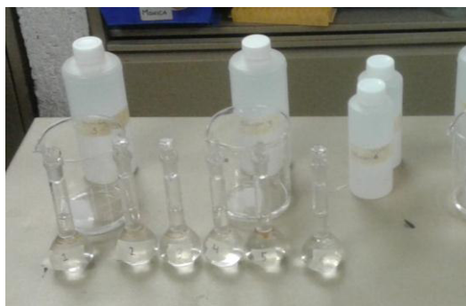
Figura 42. Soluciones para la curva patrón en matraces de 10 mL.
