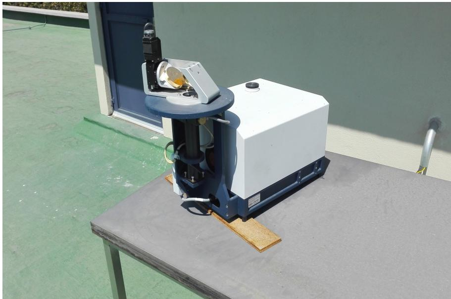
Figura 3.4: Espectrómetro EM27/SUN en la estación CCA-UNAM.
