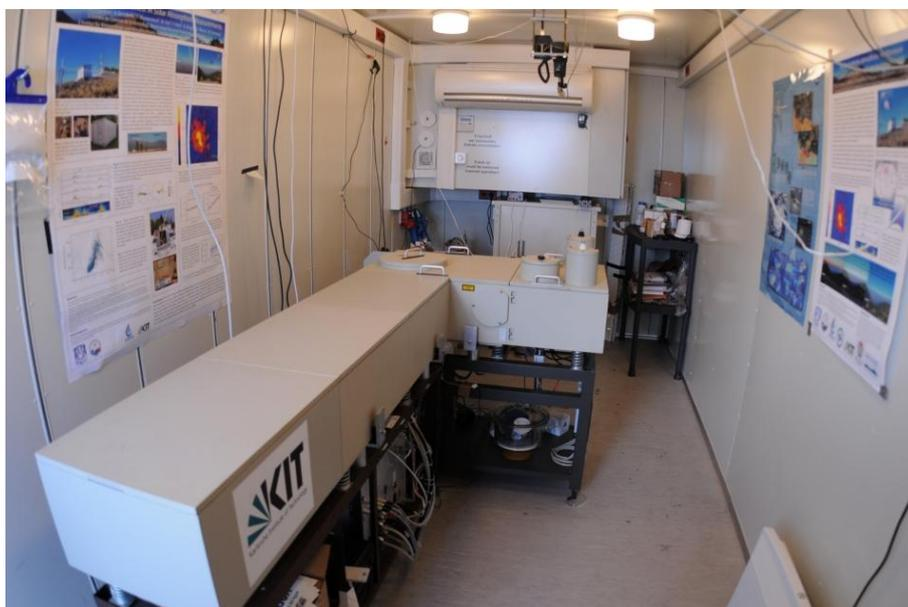
Figura 3.1: Espectrómetro IFS 120/5 HR instalado en Altzomoni.
