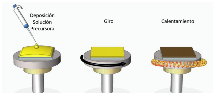
Fig. 2.8 Esquema representativo del método de spin coating de un paso
