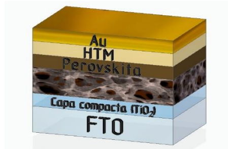
Figura 2.6 Vista transversal de la estructura bicapa utilizada en celdas solares híbridas de perovskita.
