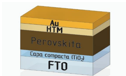
Figura 2.7 Vista transversal de la estructura plana utilizada en celdas solares híbridas de perovskita.
