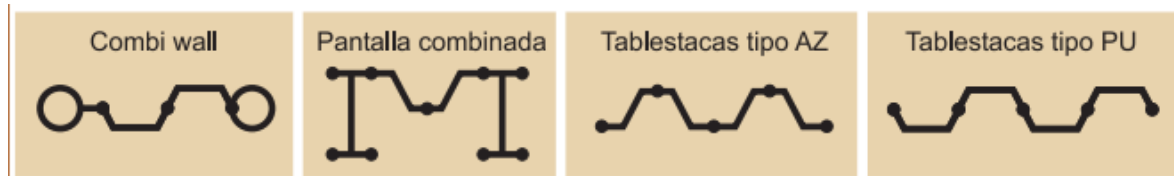
Figura 11 Configuración tablaestacas (CIMESA, 2012).
