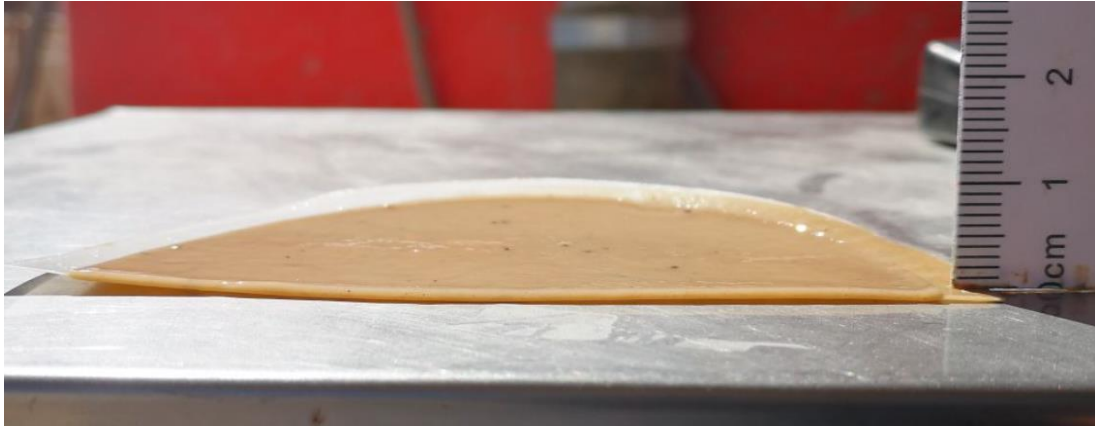
Figura 9 Resultado prueba de Cake en lodo bentonítico antes de colar Muro Milán.
