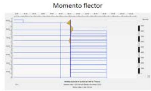
Fase 3. Segunda excavación y construcción S2 y S3
