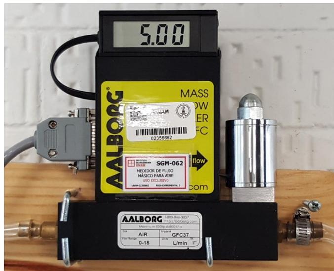
Figura 5.4. Controlador de flujo másico de gases
