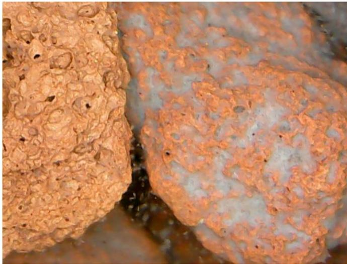
Figura 6.9. Medio de soporte (tezontle) sin y con biopelícula.
