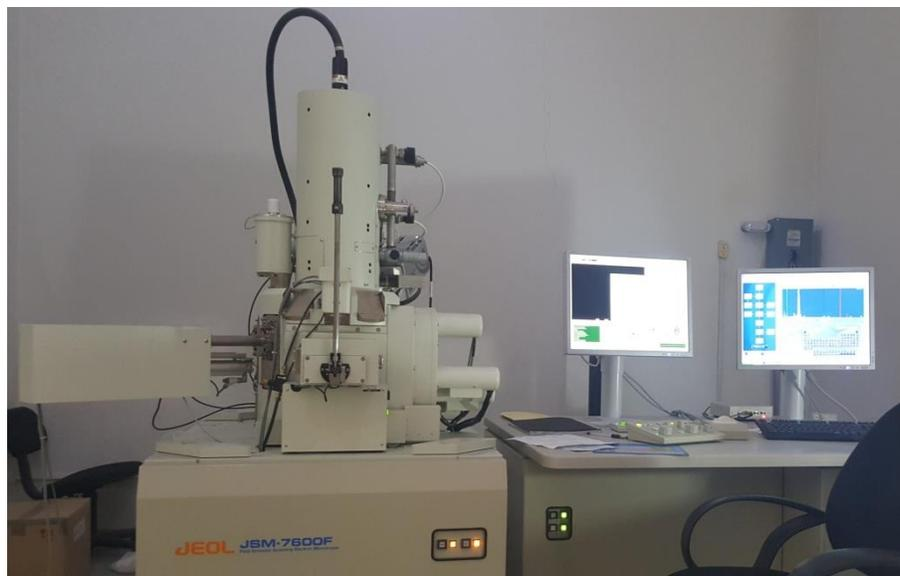
Figura 6.5. Microscopio electrónico de barrido.
