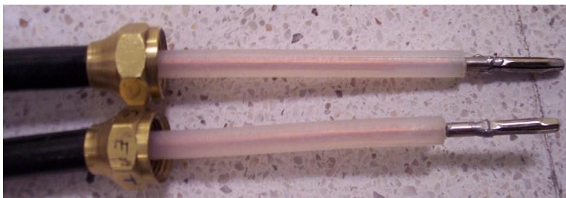
Fig. 2.30 Terminales de alto voltaje para la extensión del Mexilit al GET.
