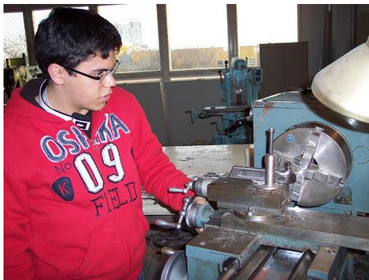
Fig. 3.4 Torneado de muestras cilíndricas
