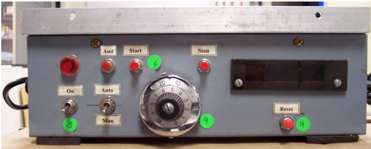
Fig. 2.16. Generador de pulsos con retardo variable re-ensamblado.
