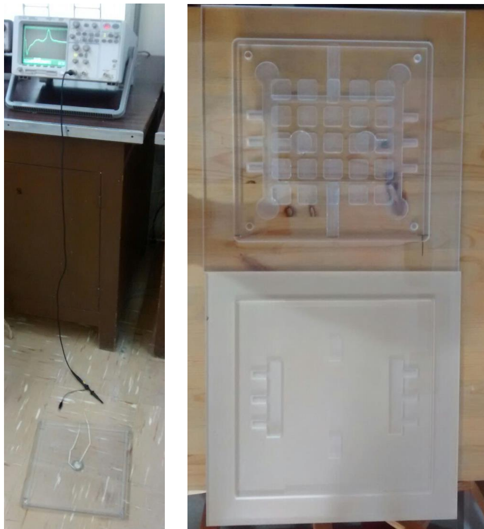
Figura 90. Piso piezoeléctrico diseñado en una placa de acrílico.
