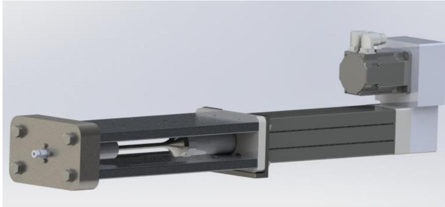
**Figura 5.13.** *Ensamble de Recipiente a presión 17-7 PH y actuador eléctrico IDC 5 KOLLMORGEN*
