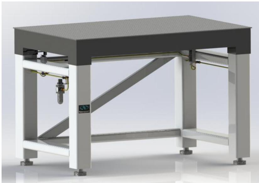
**Figura 5.1.** Mesa Vision IsoStation del laboratorio de Reología-Óptica, con capacidad disponible de 1300 lb, equipada con aisladores neumáticos que reducen vibraciones verticales y horizontales atenuadas en un 85% para menos de 5 Hz y en más del 95% por arriba de 10 Hz.
