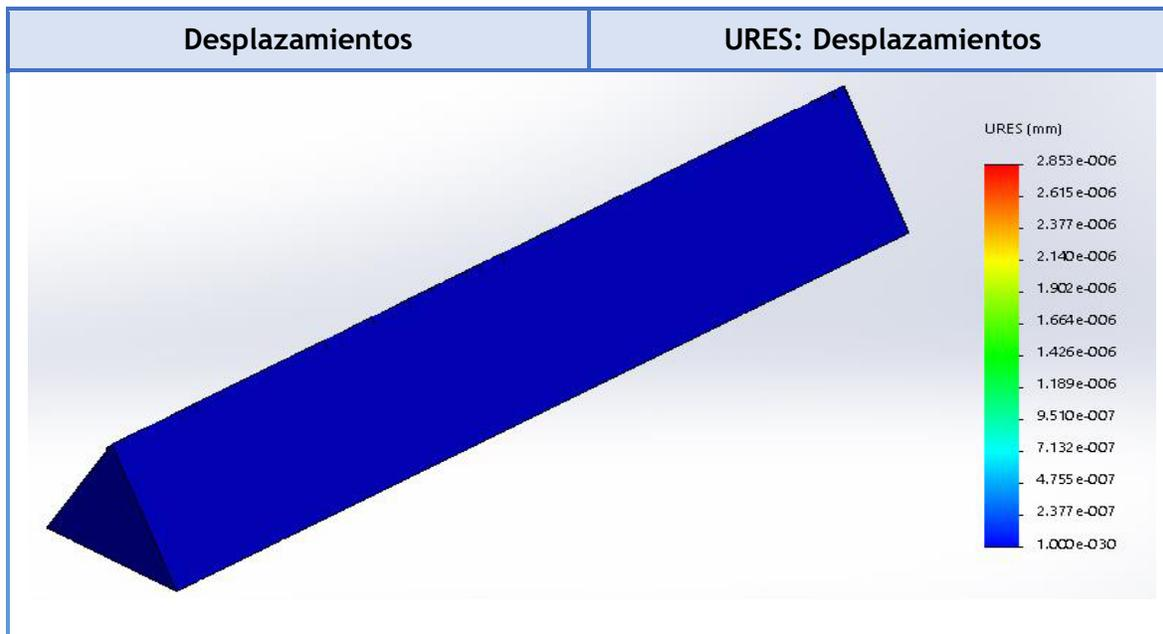
*Figura 4.5. Resultado de desplazamiento obtenida por MEF. Fulcro material 17-7 PH con una carga en la arista de 50 Kg.*
