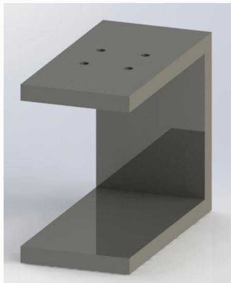
**Figura 5.2** Vista isométrica de Prensa en C, mostrando su parte superior con 4 barrenos que unirá la mesa de trabajo.
