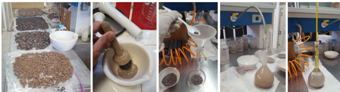
Figura 60. Proceso para la obtención de la densidad de sólidos en matraz de 500 ml, tamaño grano < malla 4
