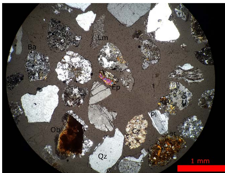
Figura 66. Sección delgada para el material de profundidad 7.20-7.32 m. Presencia de plagioclasa con macla típica de la albita, cuarzoes euhedrales muy fracturados, obsidiana devitrificada, líticos volcánicos de composición básica y sedimentarios como limolita, areniscas pobremente seleccionadas, arcillolita y caliza. Cristal anhedral de epidota al centro del campo visual. XPL Nícoles cruzados, aumento 50x.
