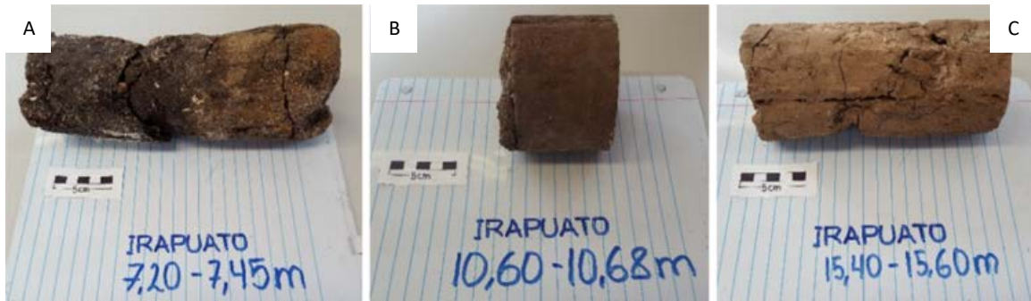
Figura 56. Muestras típicas del sondeo de Irapuato extraídas de tubo Shelby. Cada muestra fue caracterizada texturalmente con el fin de identificar la variabilidad granulométrica en profundidad. A) Graduación textural de la muestra 7.20-7.45 m debido a la presencia de arcillas hacia el techo y cambio gradual hacia arenas y limos en la base. B) Textura limo arenosa predominante de la muestra 10.68-10.83 m. C) Material areno arcilloso perteneciente al intervalo de profundidad 15.40-15.60 m.
