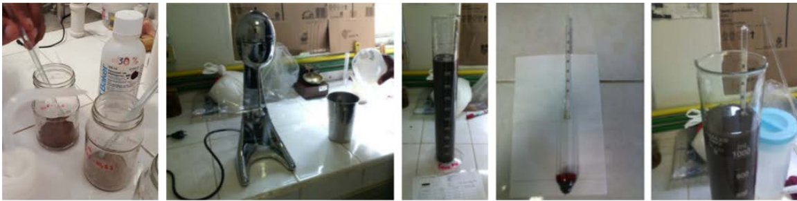
Figura 62. Proceso para la obtención de los porcentajes granulométricos de la fracción fina por el método del hidrómetro
