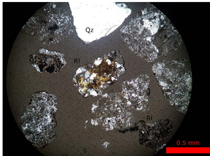
Figura 68. Sección delgada para el material de profundidad 15.40-15.60 m. El centro de la imagen presenta un fragmento de riolita con matriz devitrificada y textura esferulítica. Puede observarse el intercrecimiento de cristales de cuarzo y feldespato alcalino en esta roca extrusiva de composición ácida. En la parte superior fragmento de cuarzo proveniente de una arenisca con cemento silíceo, pueden verse bahías de disolución por reacción entre el cuarzo y el cemento criptocristalino. XPL Nícoles cruzados, aumento 100x.
