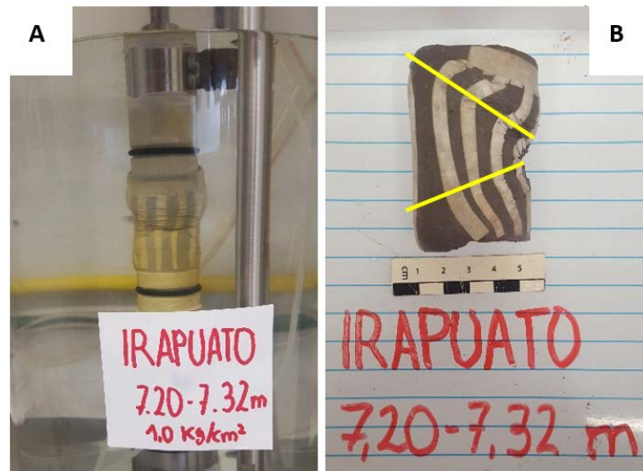
Figura 85. A) Modo de falla al final del ensaye triaxial cíclico para la probeta IR-7-SM-Pg (C). B) Fallas conjugadas en el espécimen.
