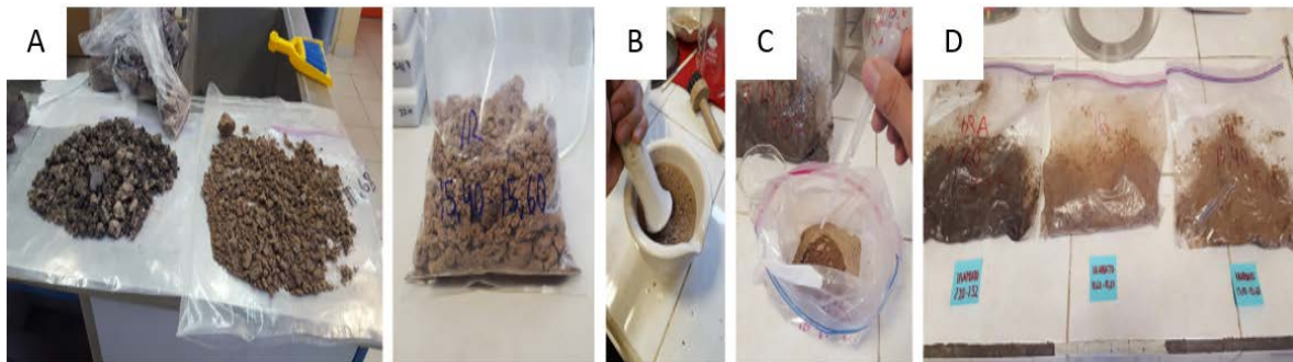
Figura 70. Preparación del material granular para la elaboración de probetas remoldeadas. A) Proceso de secado al aire del material granular. B) Disgregación de la muestra. C) Adición de agua destilada. D) Homogeneización de la muestra en recipiente plástico sellado.
