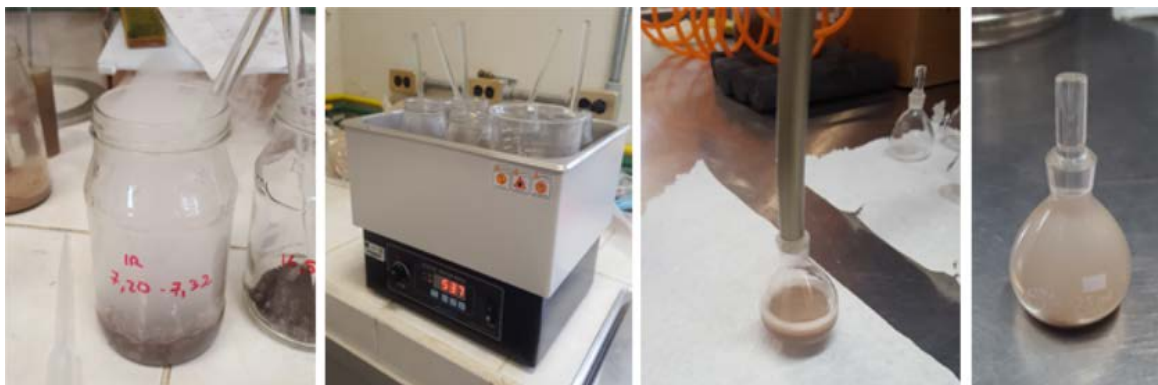
Figura 59. Proceso para la obtención de la densidad de sólidos por el método del picnómetro, tamaño grano < malla 10
