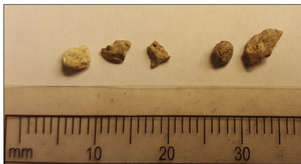
Figura 87. Angularidad en los bordes de las partículas para la fracción arena gruesa del material IR-10-SC-Qz.
