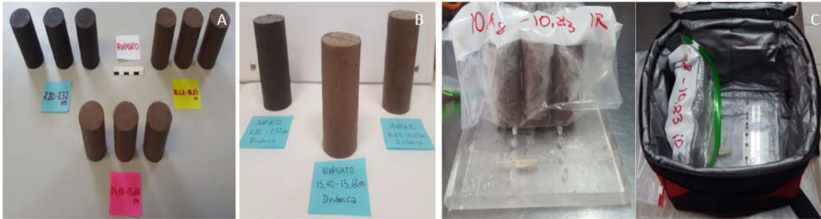
Figura 72. A) Probetas remodeladas elaboradas para las pruebas triaxiales CU en condiciones estáticas (3 por intervalo de profundidad). B) Probetas remodeladas elaboradas para las pruebas triaxiales CU en condiciones Cíclicas (1 probeta por intervalo de profundidad). C) Condiciones de almacenamiento previo al ensaye triaxial.
