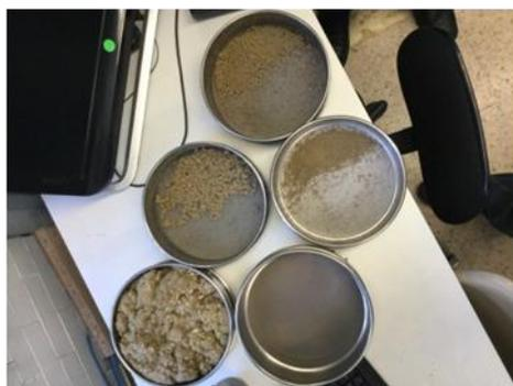
Se puede observar en la figura anterior como en cada malla se va separando gradualmente el acetato del papel y el tabaco, y las cenizas se depositan en la última charola.
