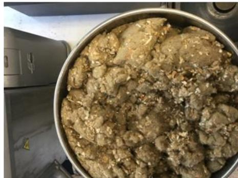
Malla 1. Serie de Tyler 8 en esta malla se colocó la molienda. Se puede observar la mezcla homogénea del papel, tabaco y acetato de celulosa.
