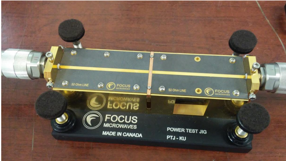
Figura 98.- Test fixture para el transistor
