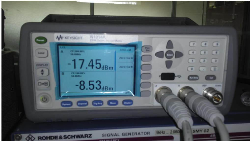
Figura 112.- Potencia de entrada (arriba) y de salida (abajo)
