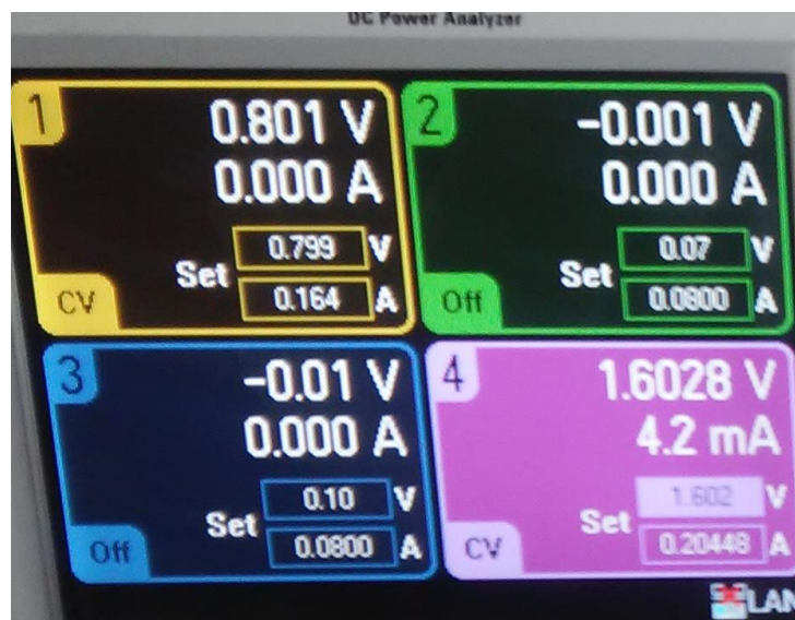
Figura 115.- Voltaje y corriente de drenaje (canal 4)
