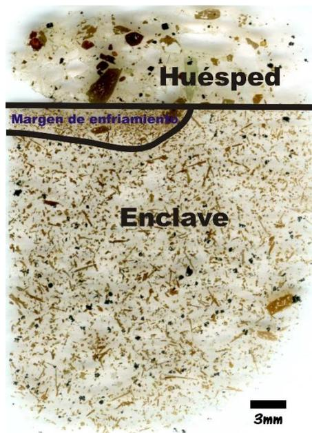
Figura 9. Microfotografía de una sección pulida de los enclaves máficos del volcán el Chichón Chiapas, en donde se observa el contacto con la roca huésped y se aprecia un margen de enfriamiento con los cristales son de menor tamaño.
