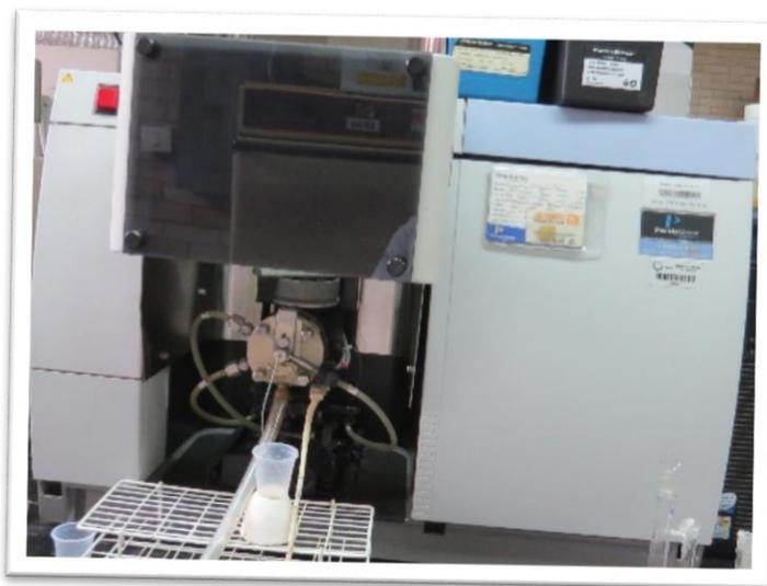
**Figura 30. Espectroscopio de Absorción Atómica empleado en los análisis.**
