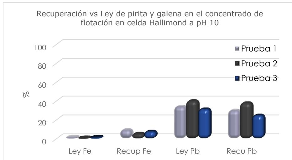
**Figura 27. Recuperación y leyes de pirita y galena empleando celda Hallimond a pH 10 en presencia de XEK,  $\text{CuSO}_4$  y 10 ppm de T5**
