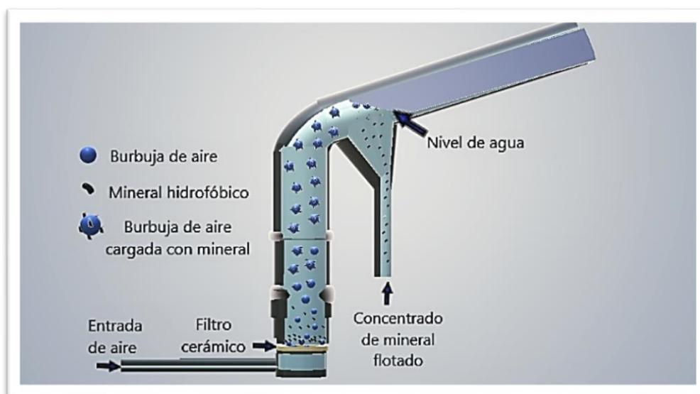
**Figura 9. Representación de la celda de flotación Hallimond**
