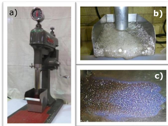
**Figura 12. a) celda de flotación Denver utilizada en la experimentación, b) colección de espuma cargada con mineral y c) concentrado obtenido**
