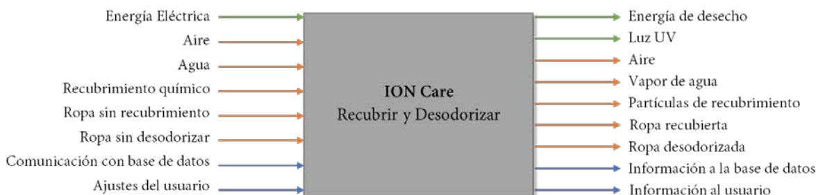
Figura 37. Diagrama de caja negra
