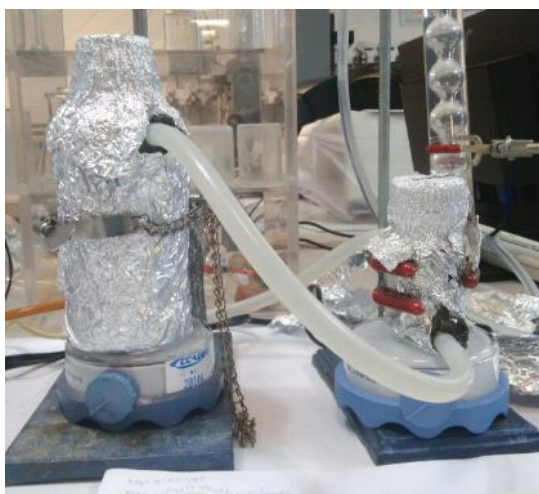
Figura 2.1. Sistema de reacción de depósito-precipitación con urea (DPU)
