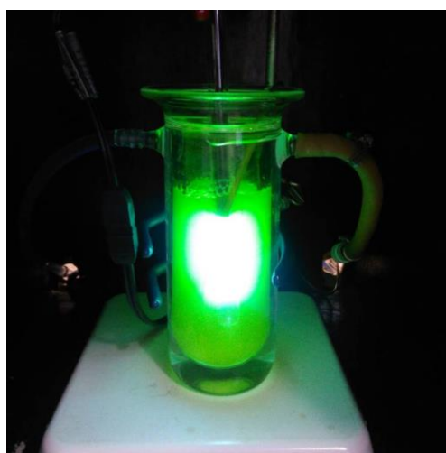
Figura 2.7. Sistema de reacción fotocatalítica con luz UV
