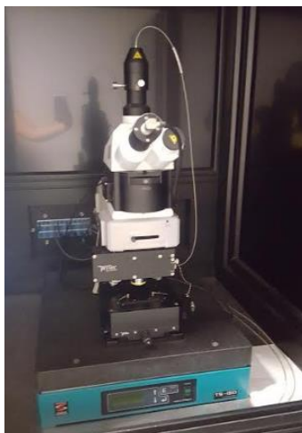
Figura 2.2. Microscopio de fuerza atómica para técnica Raman
