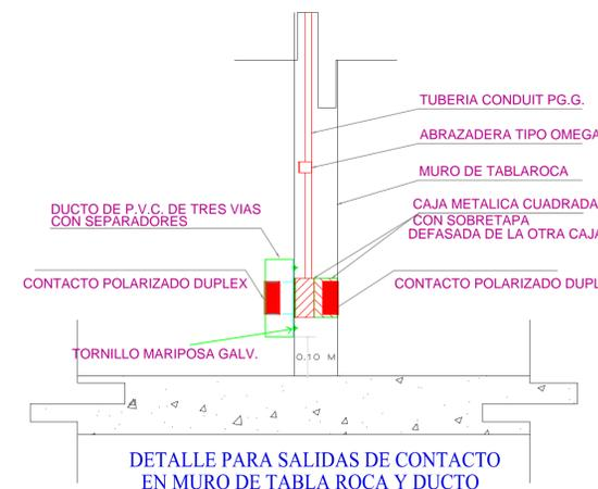
DETALLE PARA SALIDAS DE CONTACTO EN MURO DE TABLA ROCA Y DUCTO
