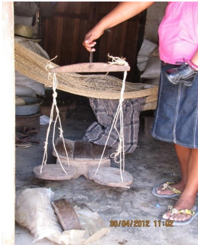
Imagen 16: Balanza de madera P'isib , sostenida por hilos de soskil (hilo de henequén) que sirve para medir el peso de la cera en la comunidad de Tankuché. (Fotografía de Miguel Navarrete, 2012).
