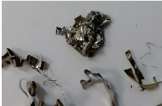
Figura 8. "Cinta" metálica obtenida durante la experimentación, bajo condiciones erróneas
