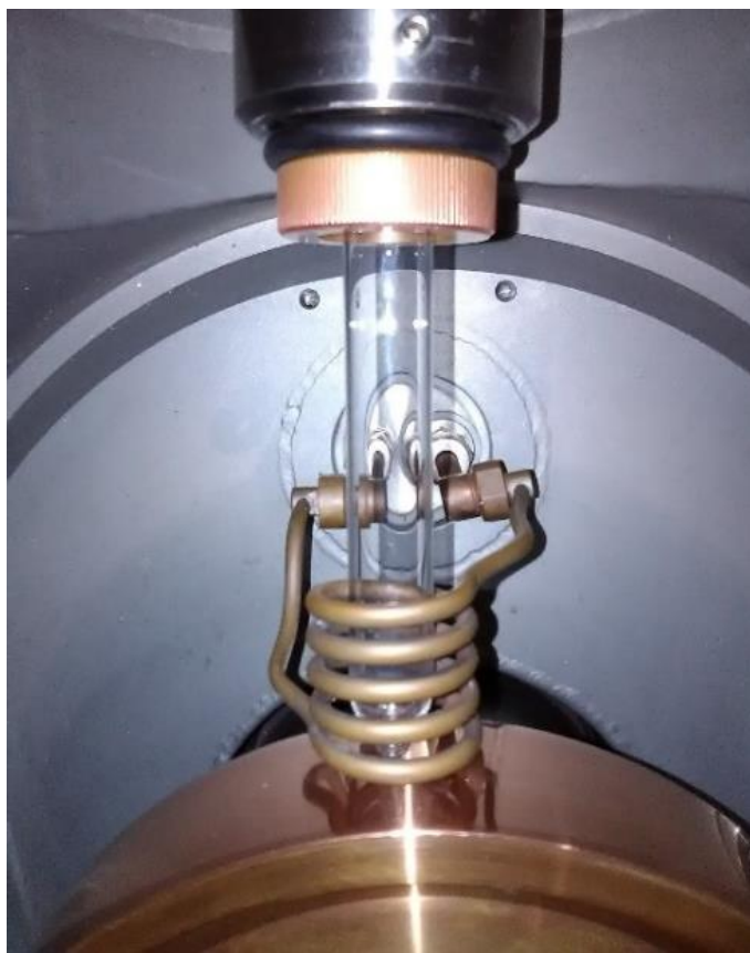
Figura 15. Crisol colocado en el "Melt-Spinner"
