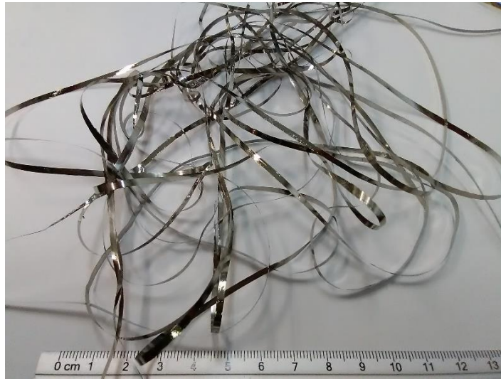
Figura 21. Cinta vítrea obtenida mediante “Melt-spinning”. Composición: Cu_{55}Hf_{25}Ti_{20}
