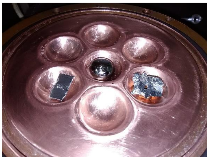
Figura 13. Elementos sin fundir en crisol de HAE
