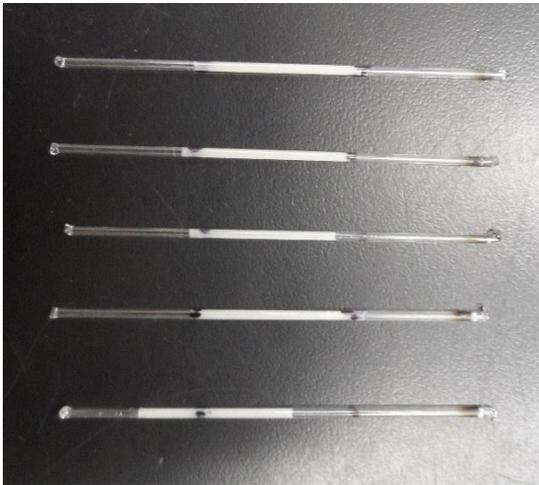
**Fotografía 7.** Tubos capilares sellados a la flama conteniendo la levadura con el crioprotector.
