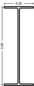
Viga principal 2 IPR de 27" x 10" Utilizada únicamente en el eje 3 entre ejes A-B, para la estancia.
