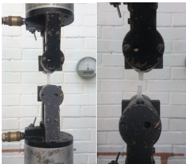
Figura 39. Ensayo de tracción de las probetas de los copolímeros de injerto.
