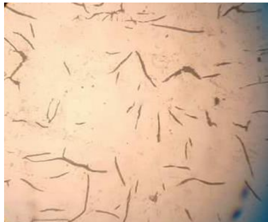
Figura 3. 3. Hierro gris con grafito tipo A.
