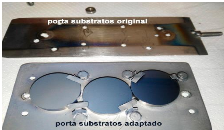
Figura 18. Porta substratos adaptado para recubrir substratos.
