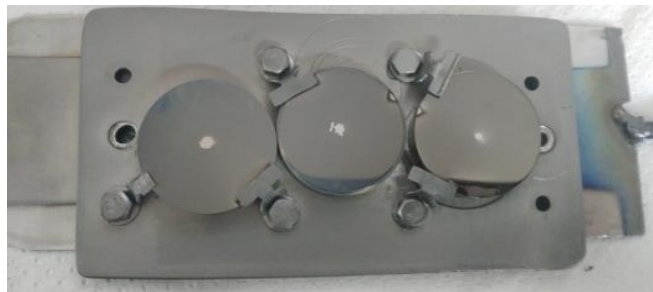
Figura 19. Muestras obtenidas después del recubrimiento de titanio y de retirar el silicón agregado.
