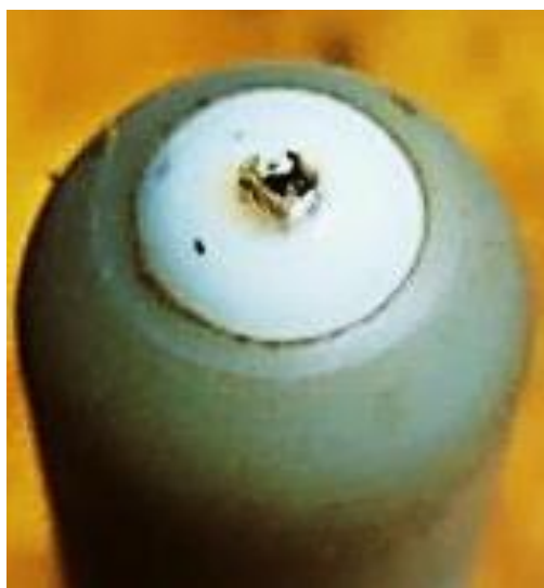
Figura 43. Fotografías del pin después del ensayo de tribocorrosión del acero con recubrimiento. Se muestran rastros de recubrimiento adheridos al pin de alúmina.
