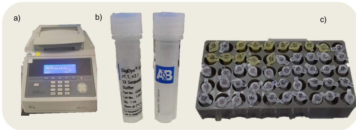
FIGURA 27 | Material utilizada para la reacción de Secuencia. a) Termociclador, b) Reactivo BigDye® y c) Tubos de PCR rotulados para la reacción de secuencia. y c) Tubos de PCR rotulados para la reacción de secuencia.
