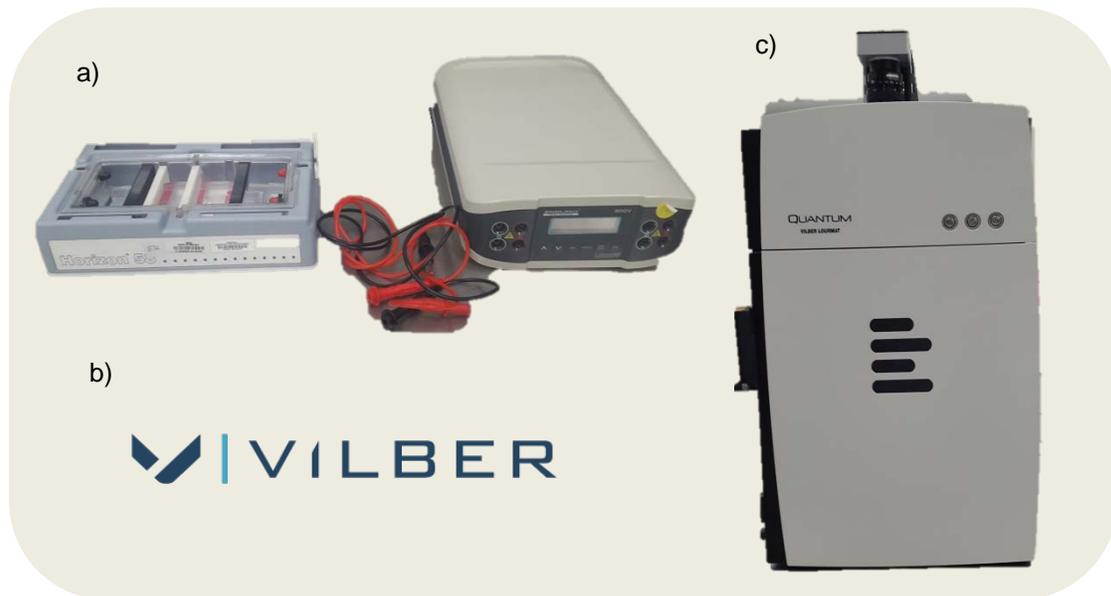
FIGURA 22 | Materiales utilizado durante la evaluación de la integridad del ADN mitocondrial. a) Cámara de electroforesis, fuente de poder con voltaje constante, claves corriente. b) Software Vision-Capt. c) Transiluminador de luz ultravioleta Quantum ST5
