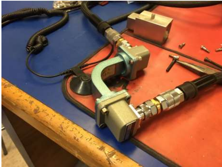
Figura 143. Guía de onda que contiene la oblea
