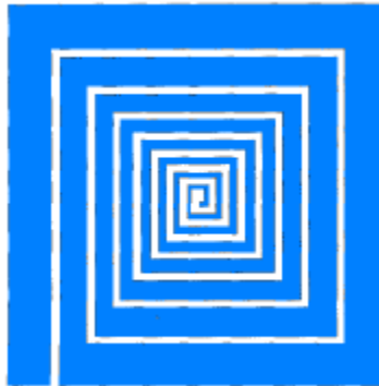
Figura 48. Espira inductora cuadrada con diferente valor de separación entre pistas. Imagen tomada de [5]
