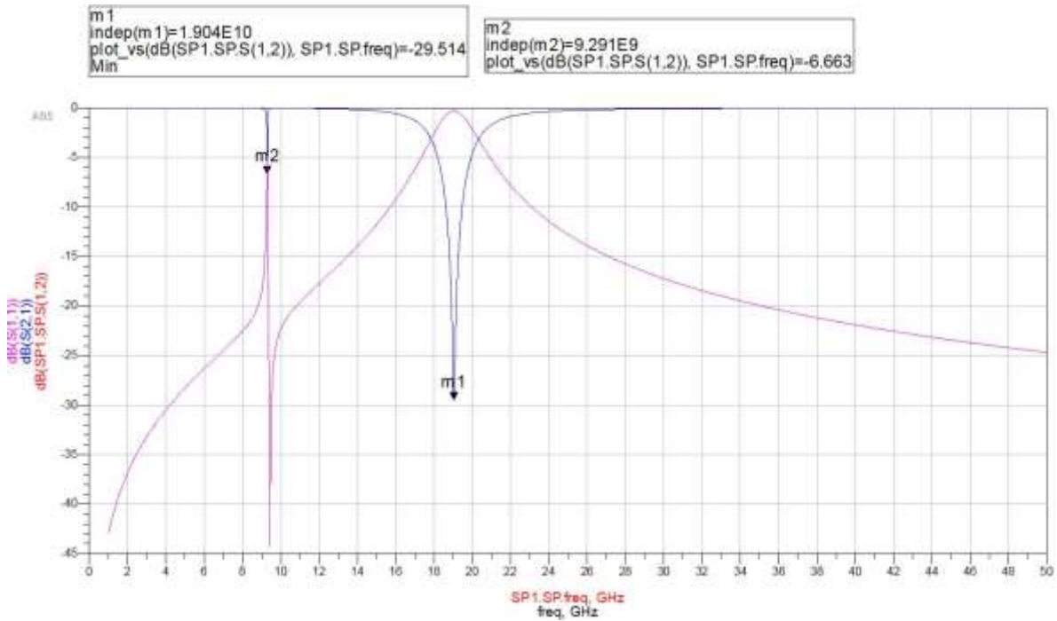
Figura 149. Gráfica de los parámetros de dispersión del anillo con inductores de 2.5 vueltas con componentes parásitas
