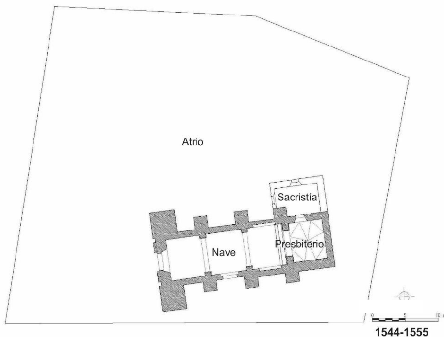
Figura 83. Reconstrucción hipotética de la planta arquitectónica del templo de Santa Catalina de Siena, Mixtequilla, Oaxaca. c. 1550. Propuesta del autor.
