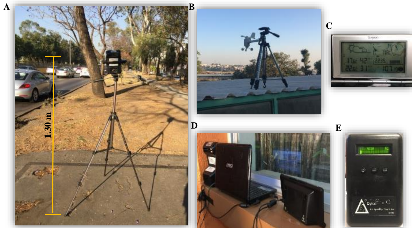
Figura 3.4 Experimento para la determinación de PM de una escuela. Posición del monitor de PM en la avenida primaria con sensor de humedad y temperatura montado (A). Sensor de viento colocado en el techo de la escuela (B) Estación meteorológica Oregon Scientific WMR89 (C) Posición de monitor de PM, estación meteorológica WMR89 y la computadora portátil dentro de un salón de clases (D) Detector nefelométrico de PM Dylos DC1700 (E).
