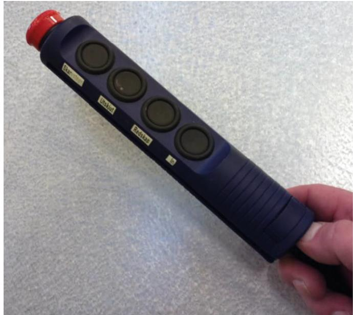
*Figura 0.11 Control remoto para el motor eléctrico*
