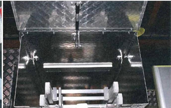
*Figura 0.6 Detalle de la CCM. Resorte neumático*
