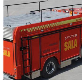
*Figura 2.5 Barandal de seguridad en el Sistema Sala*
