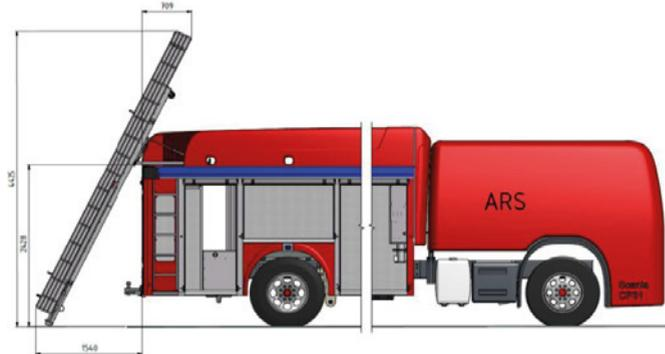
Figura 1.2 Dimensiones de la EE14 durante el desmonte
