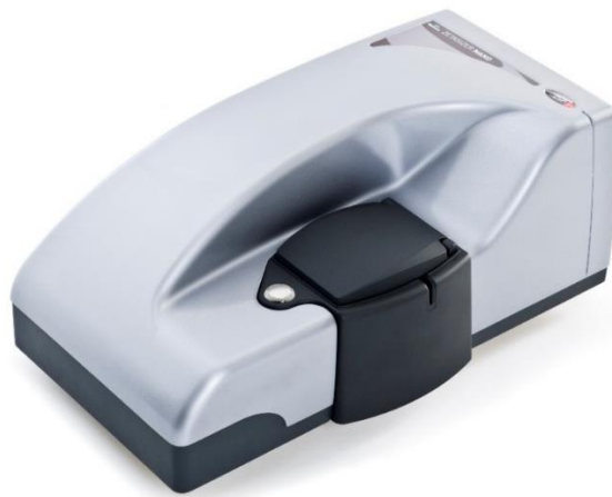
Figura 5.3. Equipo Zetasizer Nano-ZS90 utilizado para las mediciones de potencial zeta.
