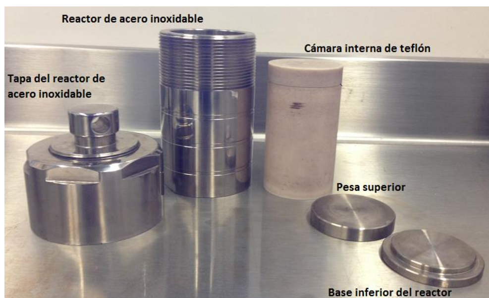
Figura 5.2. Reactor solvotermal usado para la síntesis de \text{Bi}_2\text{O}_3 .
