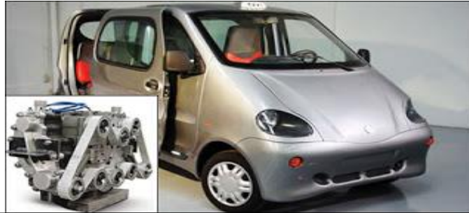
Figura 2.6: Foto de un taxi con motor de aire comprimido Sacada de: http://aireauto.blogspot.mx/
