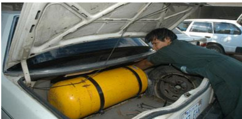
Figura2.14: Foto de la instalación de un tanque de gas a un automóvil Sacada de: http://www.bolivia.com/actualidad/nacionales/sdi/53883/entidad-de-conversion-transformo-30477-coches-a-gnv-en-2012
