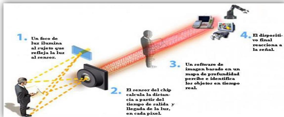
Ilustración 5 Diagrama de funcionamiento del Kinect [17].
