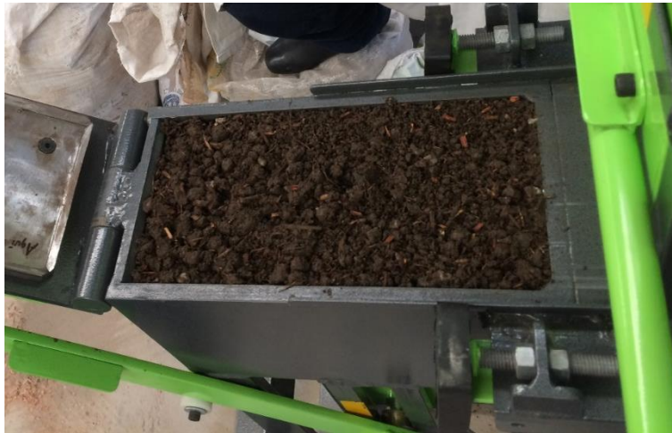
Figura 111. Material dispuesto en la cámara de prensado
