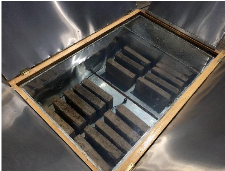
Figura 86. Ladrillos al interior del secador
