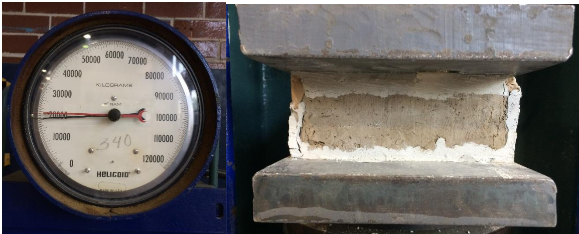
Figura 114. a) Separación de las agujas indicadoras; b) Presentación de la falla en espécimen
