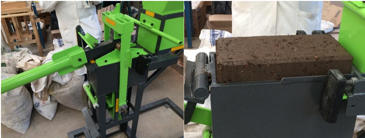
Figura 112. a) Compactación de la mezcla en la cámara de prensado; b) Extracción de espécimen
