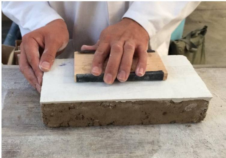
Figura 95. Lijado de la pieza para acabado final
