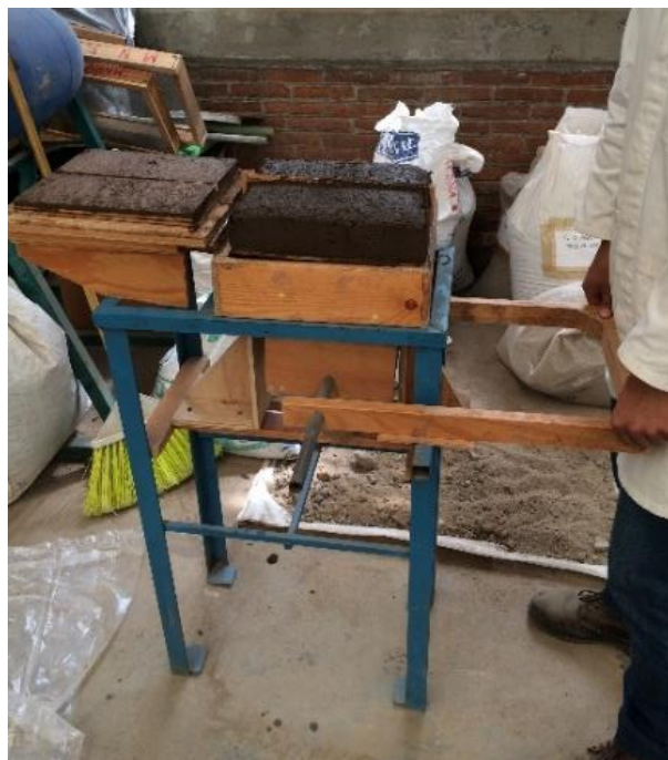
Figura 81. Extrusión de los especímenes
