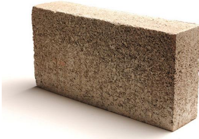
Figura 48. Ladrillo fabricado a base de PET
