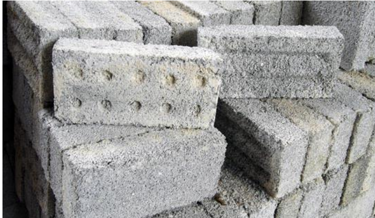
Figura 45. Ecoladrillos con residuos de PET y cemento Portland
