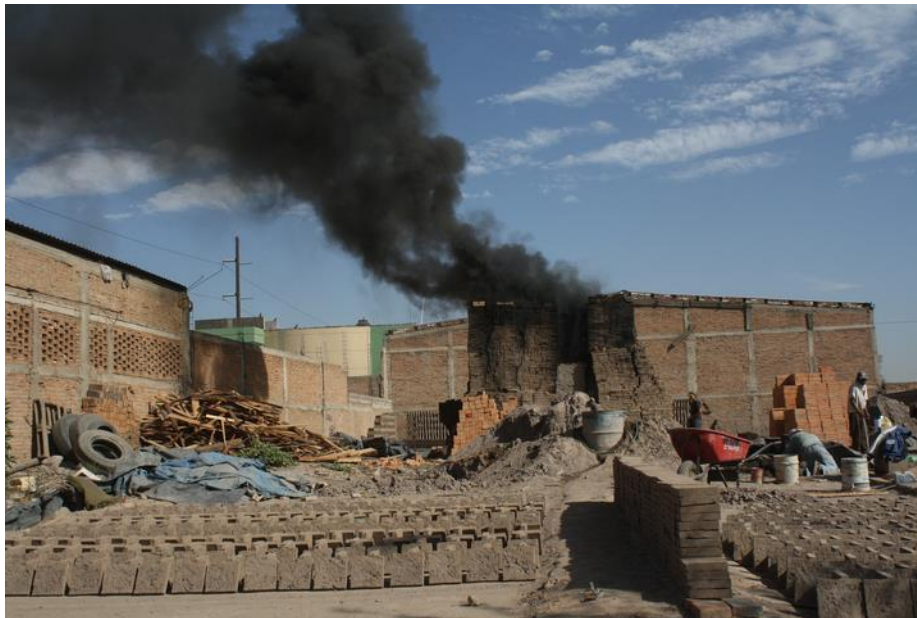
Figura 31. Emisión de gases efecto invernadero por horno ladrillero en operación
