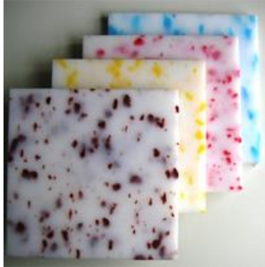
Figura 15. Tablero de polietileno reciclado prensado (Taplast)
