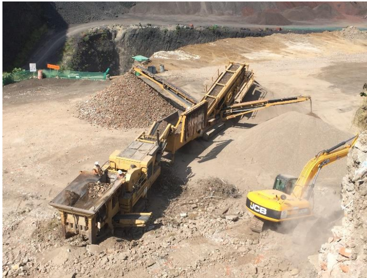
Figura 54. Obtención de agregados reciclados
