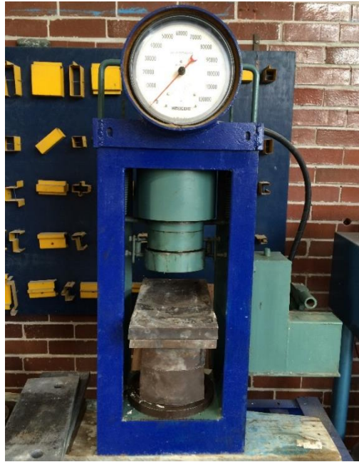
Figura 96. Colocación de placas de metal sobre base de equipo para compresión axial
