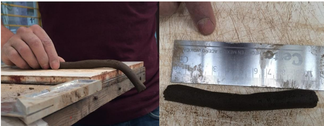
Figura 70. a) Deslizamiento de rollito; b) Medición de ruptura
