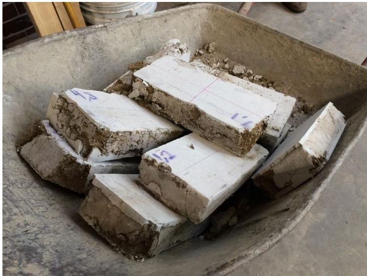
Figura 101. Ladrillos probados manteniendo su estructura
