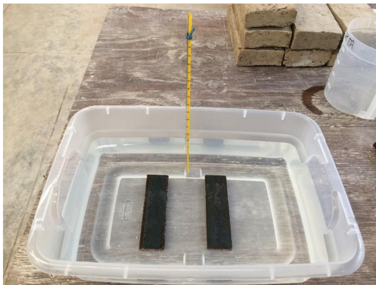
Figura 106. Preparación de recipiente para prueba de absorción total
