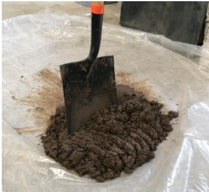
Figura 77. Consistencia adecuada de la mezcla
