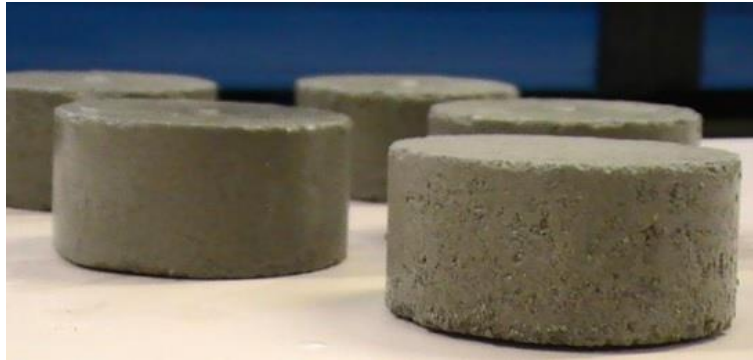
Figura 43. Probetas de ecoladrillos con cascarillas de arroz
