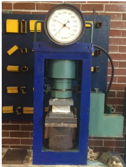
Figura 97. Colocación de ladrillo para prueba de compresión
