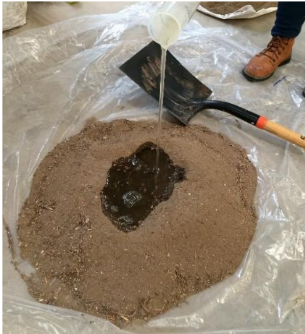
Figura 76. Vertido de mucílago a la mezcla
