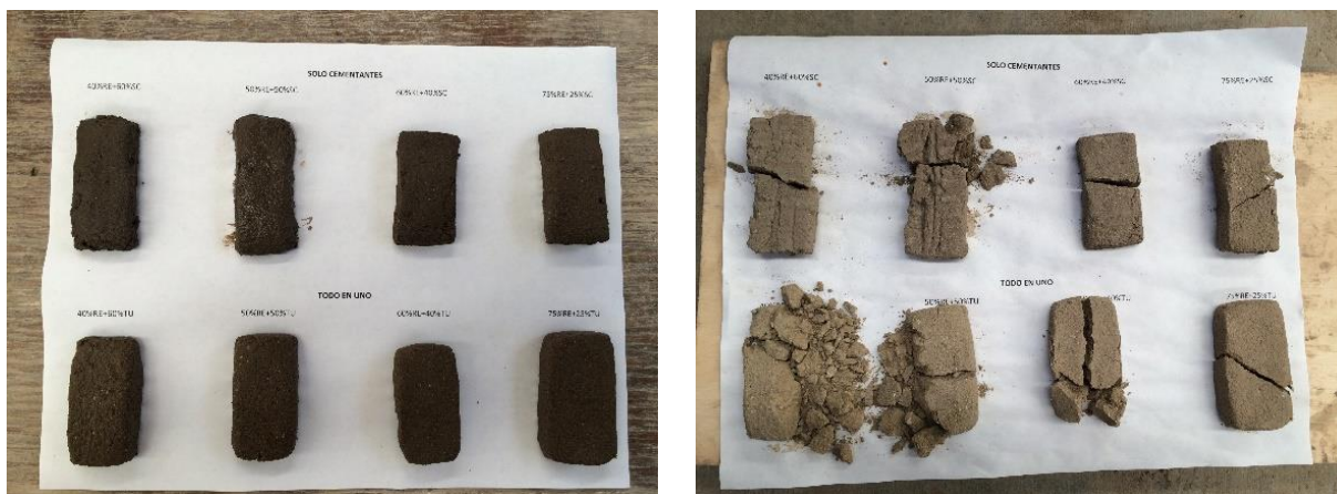
Figura 73. a) Bloques combinaciones preliminares; b) Bloques combinaciones preliminares probadas
