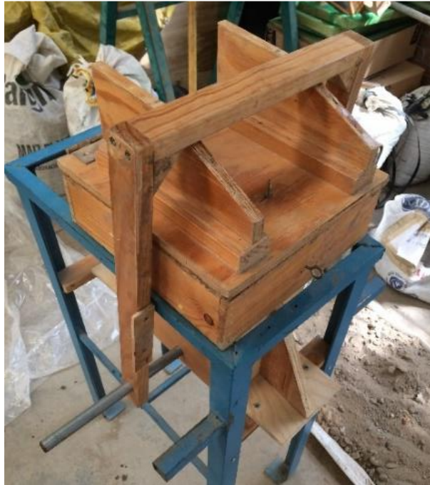
Figura 80. Prensado de la mezcla
