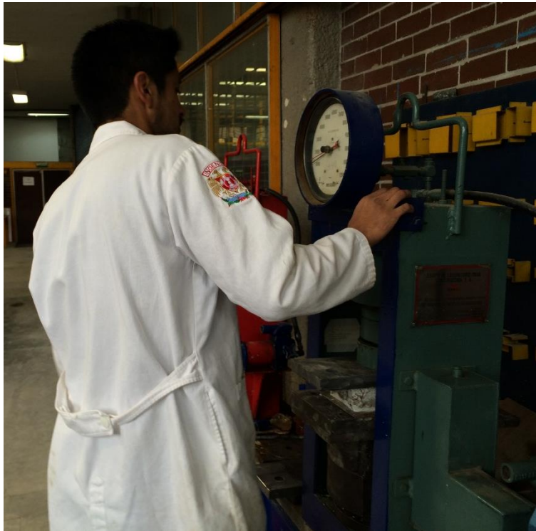
Figura 100. Toma de lectura de la carga máxima soportada por el ladrillo
