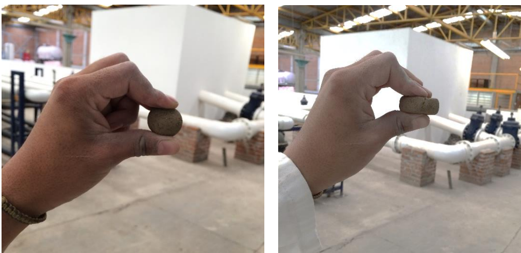
Figura 72. a) Prueba de dureza a bolita; b) Prueba de dureza a pastilla
