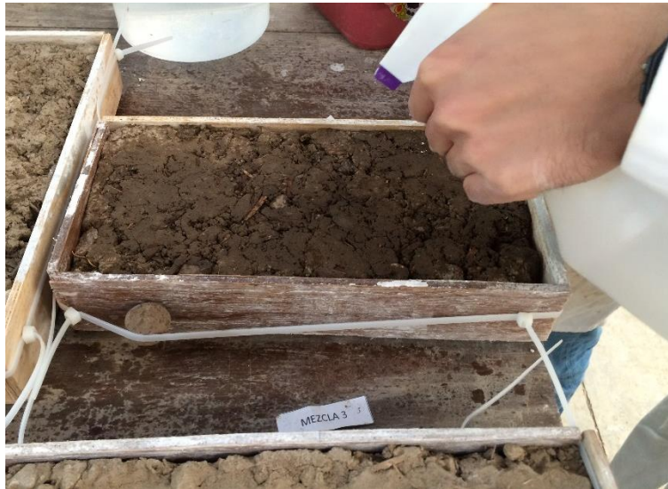
Figura 92. Humedecimiento de la superficie del ladrillo
