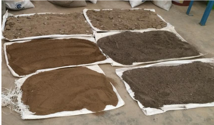
Figura 56. Secado de residuos de construcción
