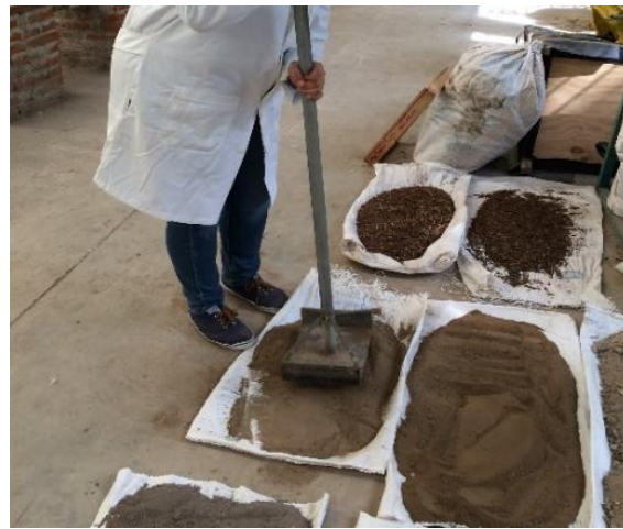
Figura 52. a) Secado del material de excavación; b) Apisonado de material de excavación
