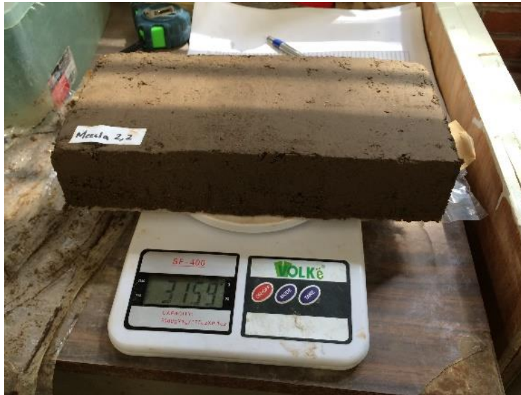
Figura 82. Pesaje de ladrillos
