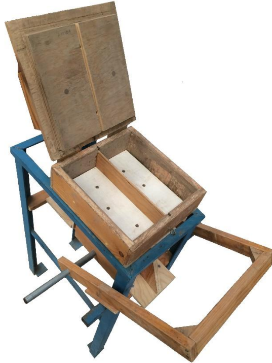
Figura 64. Máquina moldeadora de ladrillos
