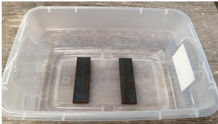
Figura 102. Colocación de barras de metal en recipiente para prueba de absorción
