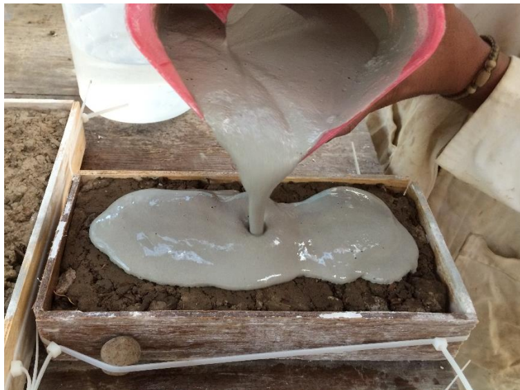
Figura 93. Vertido de mezcla yeso-cemento sobre la superficie del ladrillo
