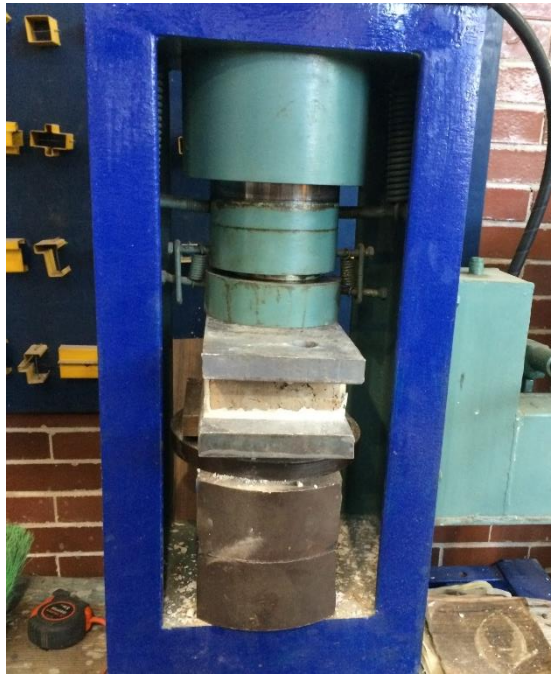
Figura 113. Adecuación de placas de acero para alineación de espécimen
