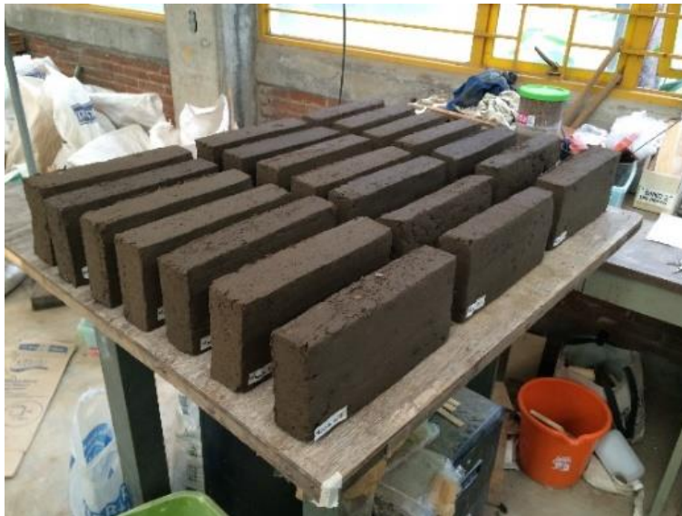
Figura 85. Volteo de ladrillos sobre su canto
