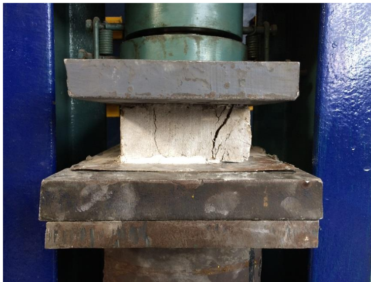
Figura 99. Presentación de la falla en el ladrillo
