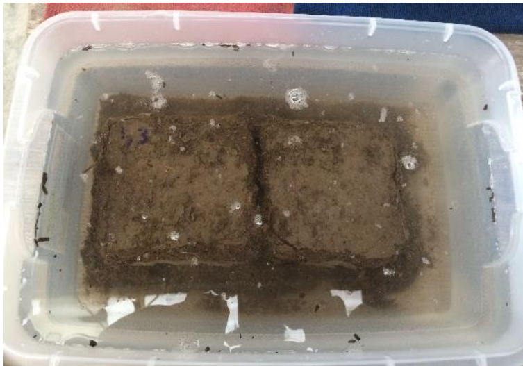
Figura 108. Indicación de término de prueba de absorción total
