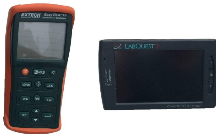
Figura 87. Equipos de medición de temperatura y radiación solar
