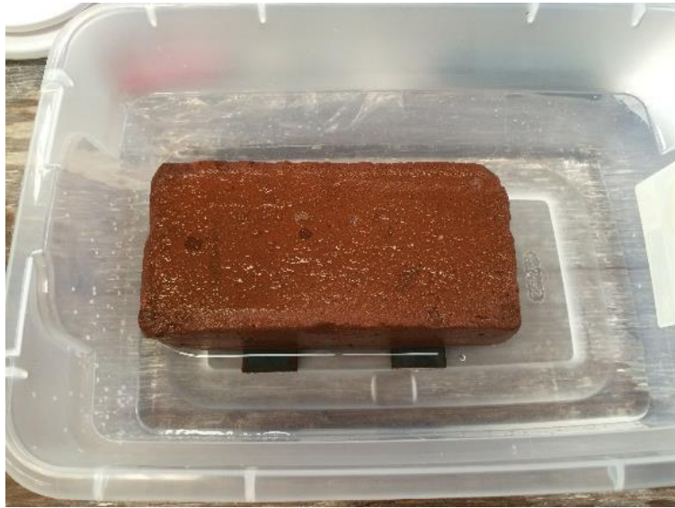
Figura 103. Ajuste de niveles con ladrillo de referencia
