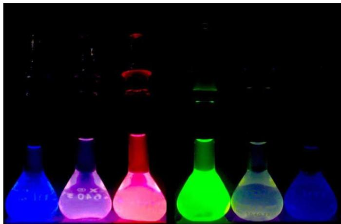
**Figura 7.9.4.1** Disoluciones del ligante *HCum* (**1**) y de los complejos SmCum (**6**) EuCum (**7**), TbCum (**9**), DyCum (**10**) y TmCum (**13**) (de izquierda a derecha) bajo la lámpara UV a 365 nm.
